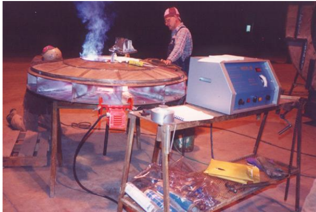
Figura 22 – Aplicação do processo VWC em componente de rotor (BONAL, 2008).
