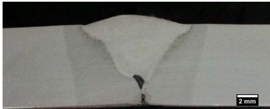
Figura 62 – Condição (B). Soldagem convencional com pré-aquecimento à 100°C e pós-aquecimento à 230°C por uma hora.
