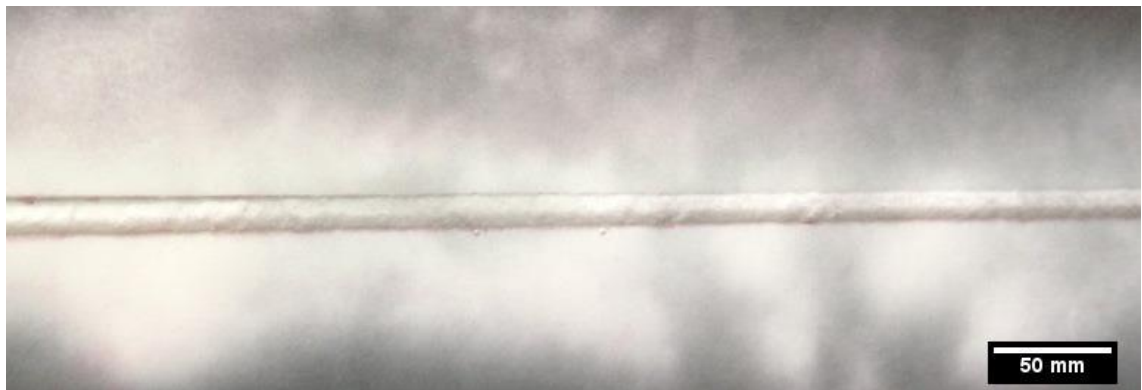
Figura 57 – Condição (B). Soldagem convencional com pré-aquecimento à 100°C e pós-aquecimento à 230°C por uma hora.
