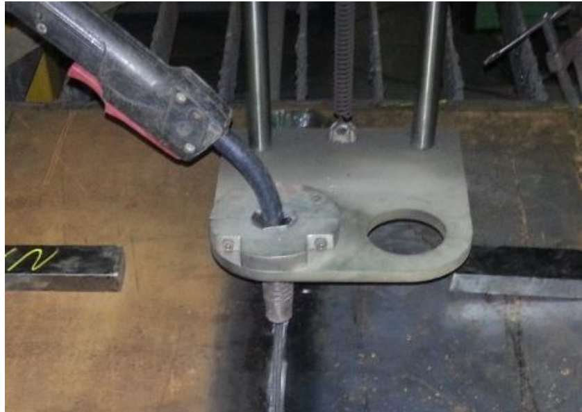
Figura 26 – Adaptação da pistola no sistema de oxicorte.
