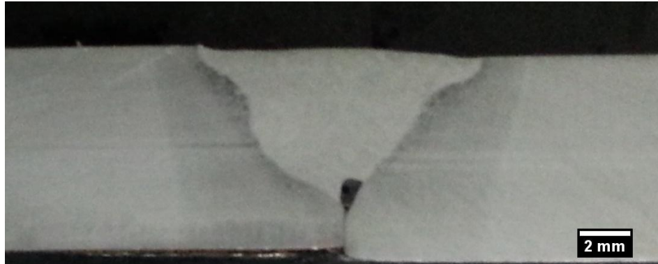
Figura 64 – Condição (D). Soldagem com tratamento vibracional de Weld Conditioning .
