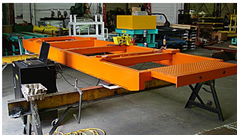
Figura 21 – Aplicação do processo VSR em componente de plataforma (BONAL, 2008).
