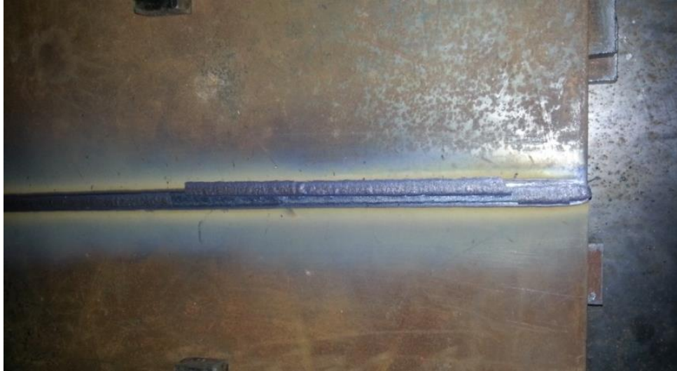
Figura 54 – Escória removida logo após a soldagem.
