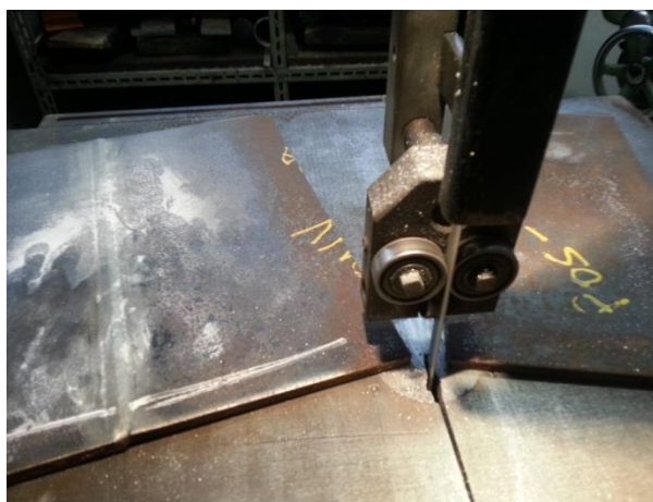
Figura 37 – Primeiro corte das juntas soldadas utilizando Serra Fita.
