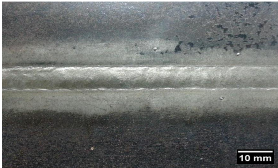
Figura 51 – Condição (C). Soldagem com tratamento vibracional de alívio tensão (Pós soldagem).
