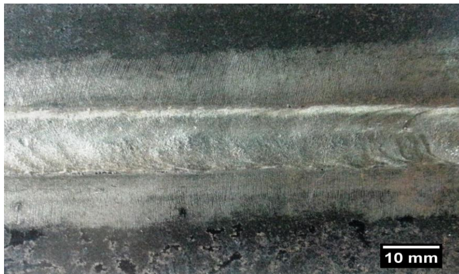
Figura 53 – Condição (E). Soldagem com tratamento vibracional de Weld Conditioning e pré-aquecimento à 100°C e pós-aquecimento à 230°C por uma hora.
