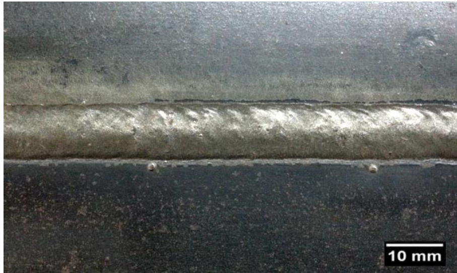
Figura 50 – Condição (B). Soldagem convencional com pré-aquecimento à 100°C e pós-aquecimento à 230°C por uma hora.
