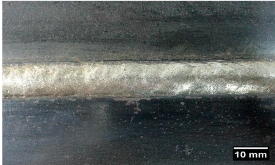
Figura 52 – Condição (D). Soldagem com tratamento vibracional de Weld Conditioning .
