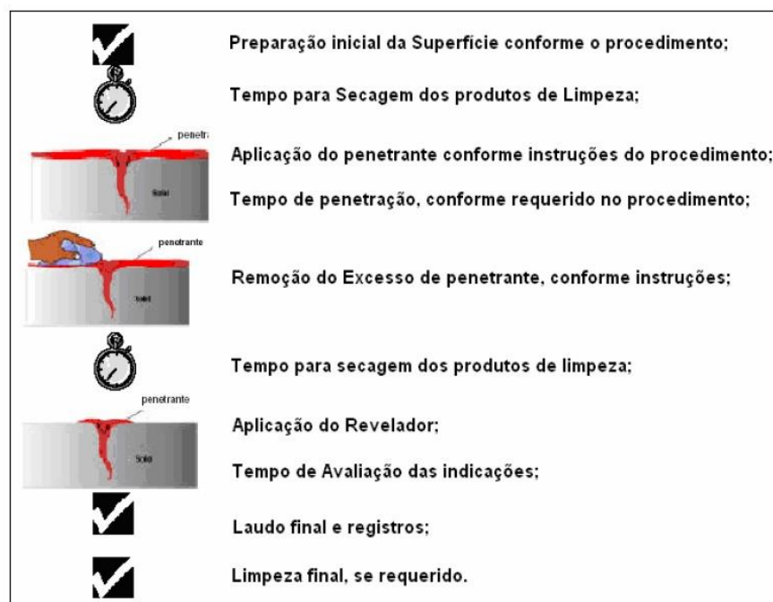
Figura 36 – Resumo da sequência do ensaio de LP (ANDREUCCI, 2006).
