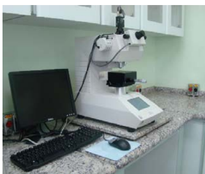
Figura 42 – Equipamento utilizado para a o ensaio de microdureza – Laboratório de fadiga – FEG/UNESP.
