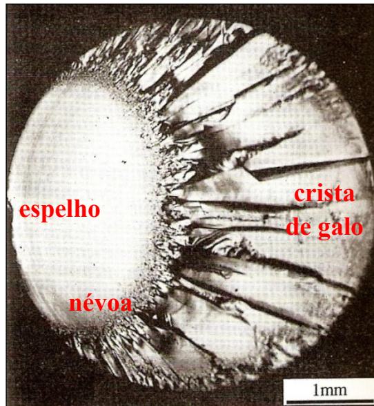
Figura 7 - Aspectos de fratura: espelho, névoa e crista de galo (HULL, 1999).
