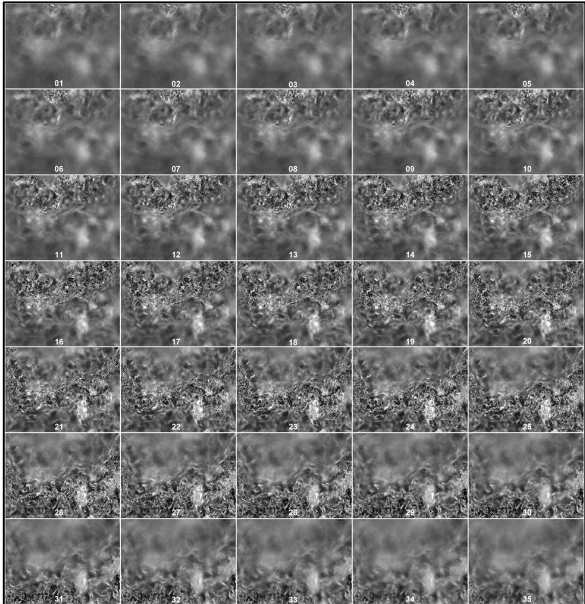
Figura 46 - Pilha de imagens com movimento progressivo da objetiva.
