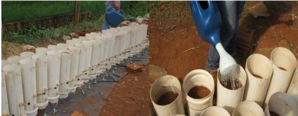
Figura 4 - Demonstração da forma utilizada para saturar os solos nas colunas, a cada 10 dias.
