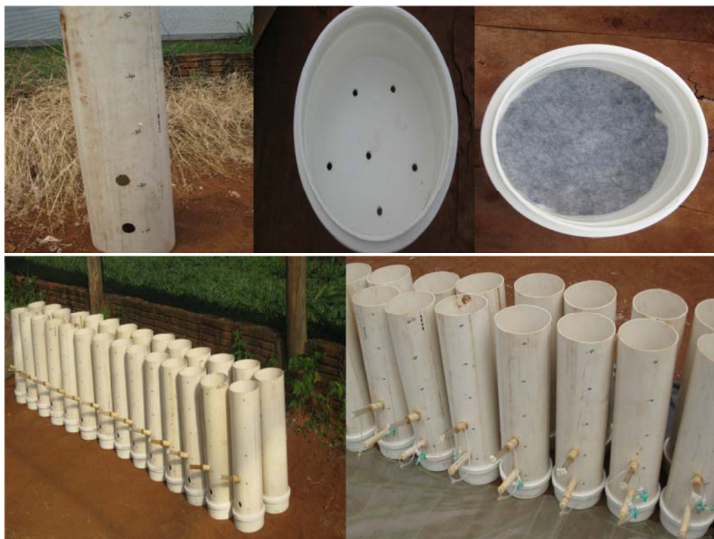
Figura 2 - Etapas de montagem das colunas de pvc utilizadas para acondicionamento dos solos em estudo.
