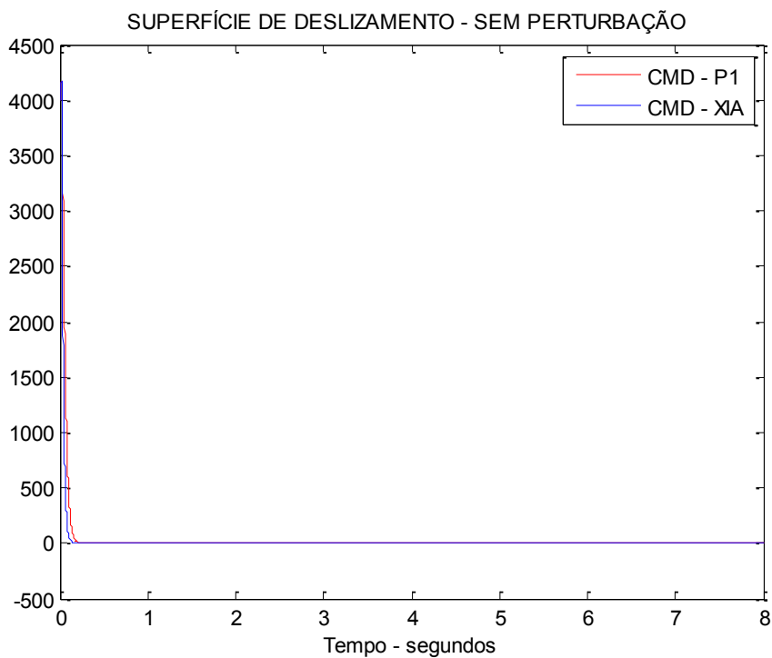
Figura 71 Superfície de deslizamento para sistema discreto sem perturbação, com período de amostragem igual a 1 ms - controles CMD-P1 e CMD-XIA.
