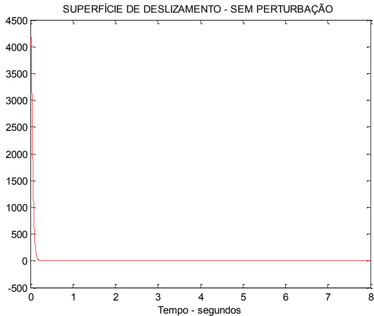
Figura 59 Superfície de deslizamento para sistema discreto sem perturbação, com período de amostragem igual a 1 ms - controle CMD-P1.
