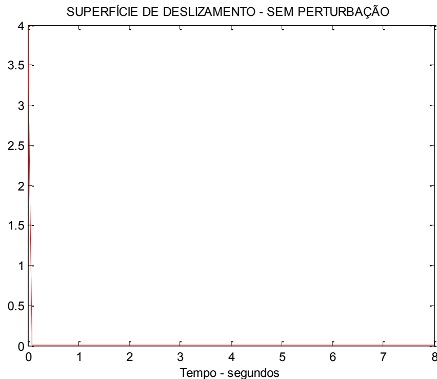
Figura 16 Superfície de deslizamento para sistema nominal - controle CEV sem perturbação, \rho = -50,0 , \delta = 0,05 .
