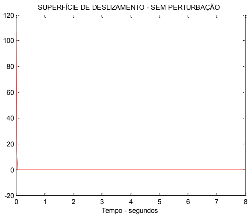
Figura 40 Superfície de deslizamento para sistema discreto sem perturbação, com período de amostragem igual a 35ms - controle CMD.
