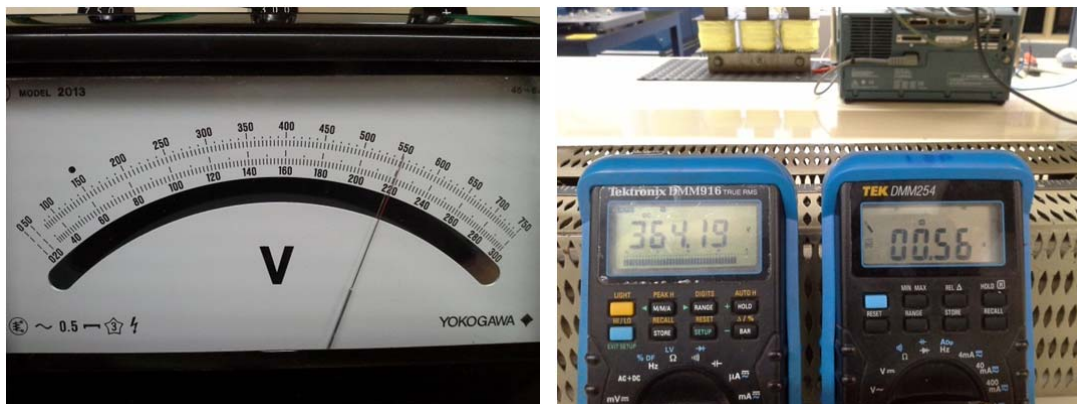
Figura 54 – Tensão de entrada, tensão e corrente de saída do estágio Boost.
