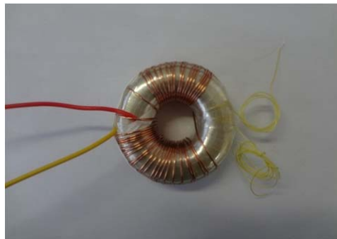
Figura 32 – Núcleo NT 300/52D Enrolado.
