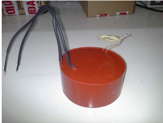
Figura 87 – Transformador elevador, de alta tensão e de alta frequência desenvolvido.
