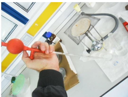
Figura 3.16- Pipetagem de 5 ml da solução
