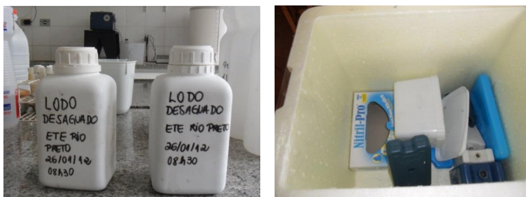
Figura 3.2 - Identificação da amostra e equipamentos usados no transporte de São José do Rio Preto à Ilha Solteira
