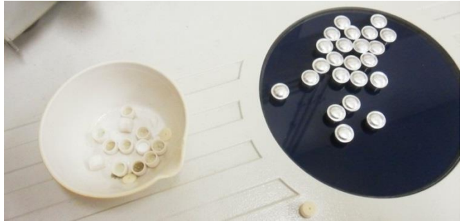
Figura 3.52 - Recipientes de alumina (1000°C) e de alumínio (600°C)
