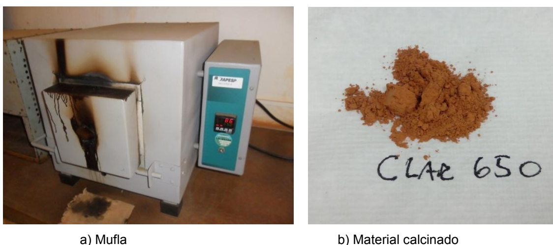
Figura 3.6 - Equipamentos usados para queima
