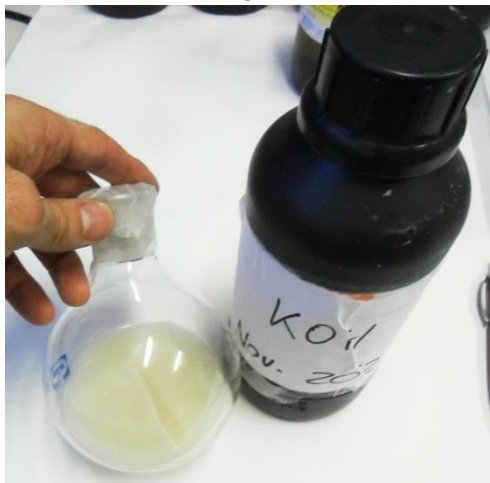
Figura 3.24 – Balão com filtro e com solução de KOH
