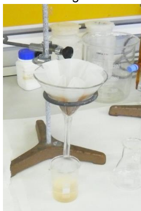
Figura 3.13- Dispositivo de filtragem
