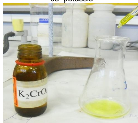
Figura 3.17- Pipetagem de 3 gotas de cromato de potássio
