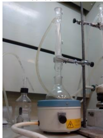
Figura 3.25 – Sistema de aquecimento e condensador
