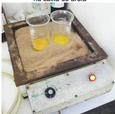
Figura 3.21- Aquecimento da solução com HCl na caixa de areia
