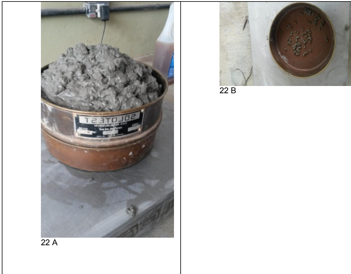
Figuras 22 - Os aspectos do concreto no ensaio de peneiramento
