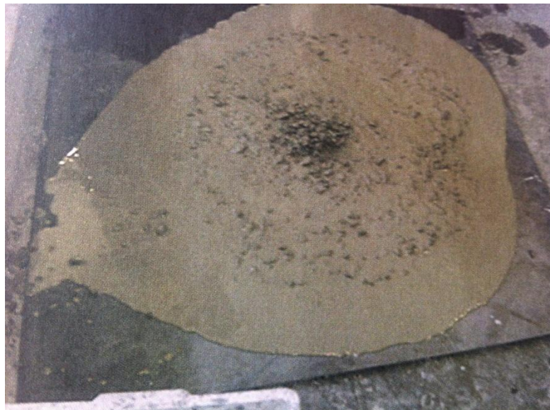
Figura 6 - Exemplo de CAA com segregação visível
