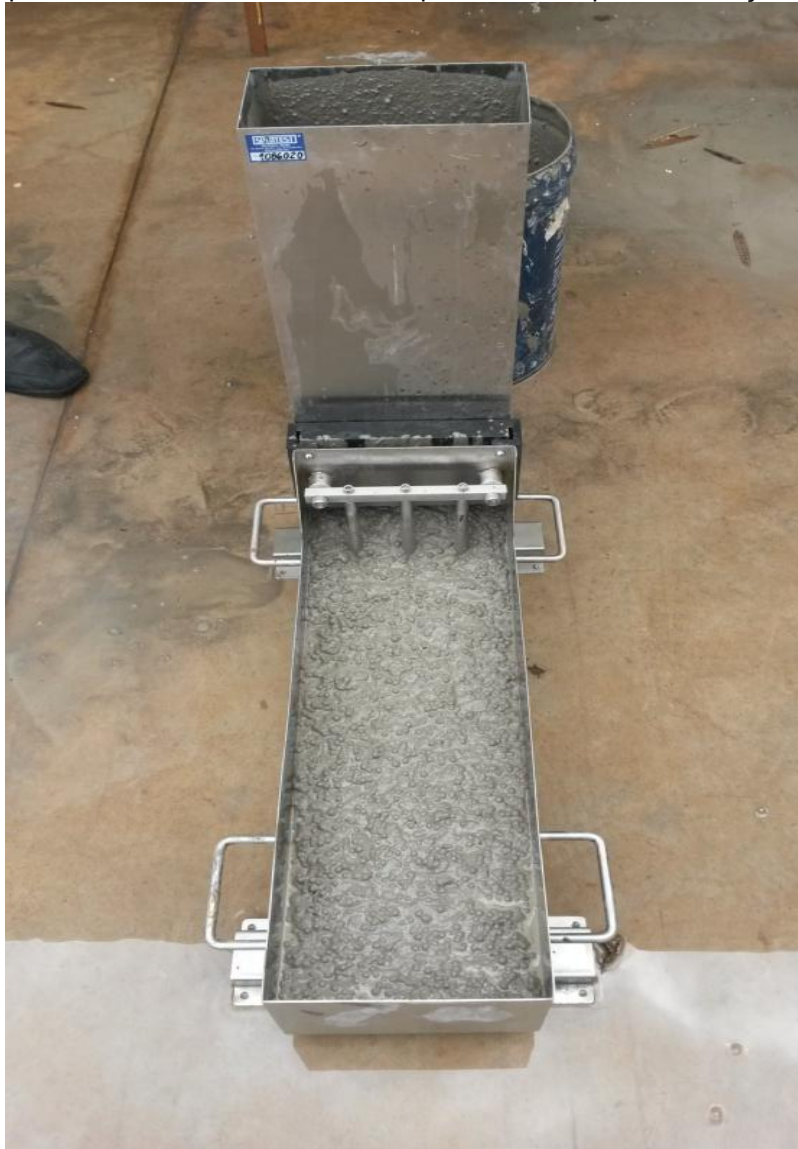
Figura 21 - Aspectos do material nos ensaios de peneiramento para a avaliação da segregação
