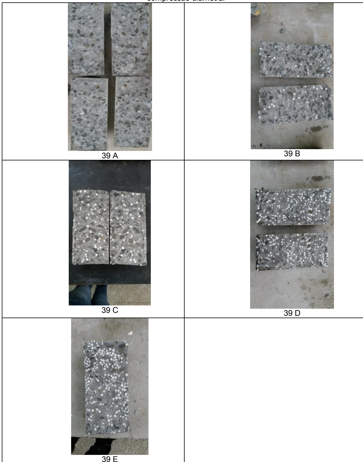
Figuras 39 - Superfícies internas dos corpos de prova após as rupturas destes em ensaio de compressão diametral
