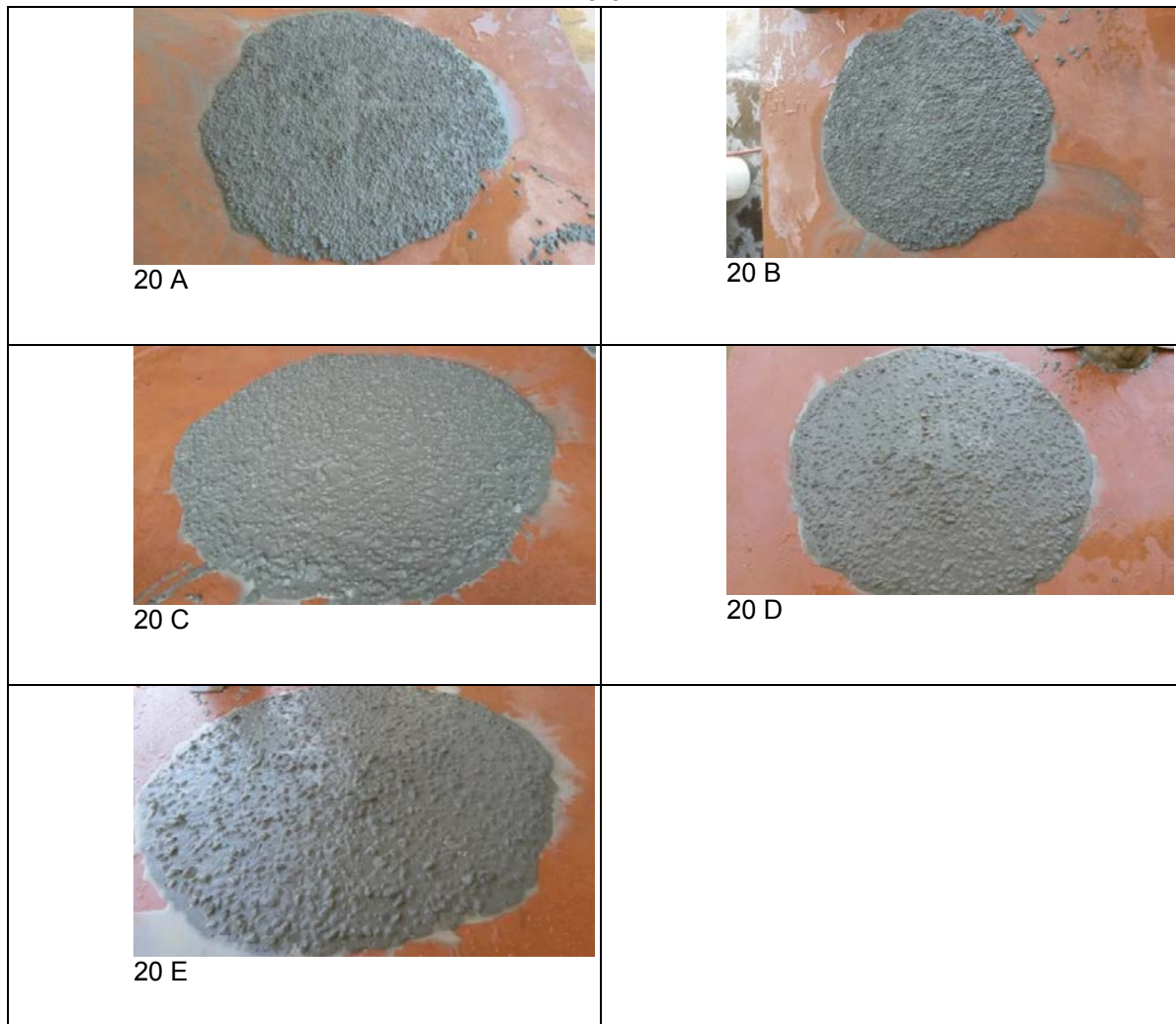
Figuras 20A a 20E: Aspectos das circunferências dos ensaios de espalhamento para as composições 1 a 5
