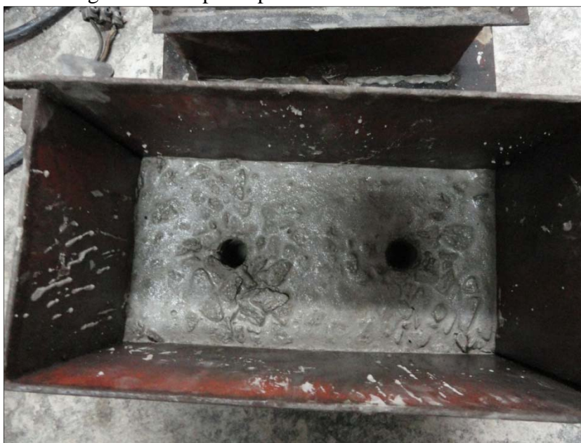
Figura 77- Corpo de prova moldado com orifícios.
