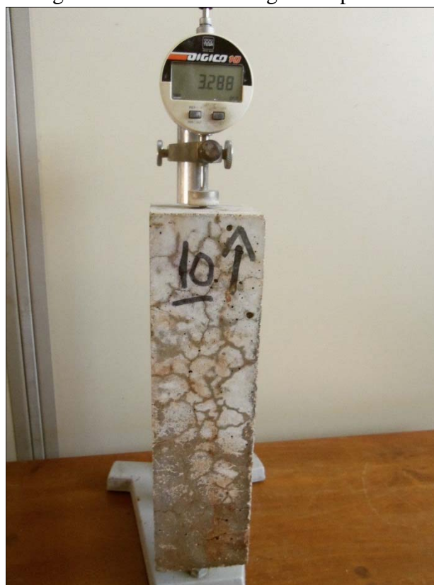
Figura 85- Prisma no relógio comparador.
