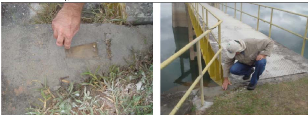
Figura 64- Marco de referência indeslocável sobre a rocha.
