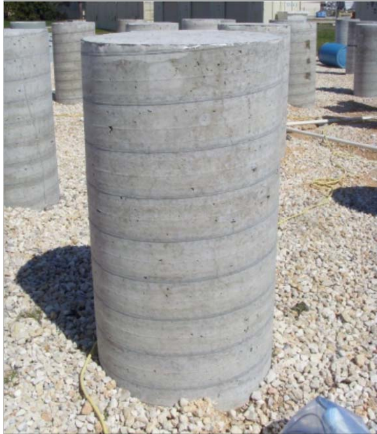
Figura 28- Corpos de prova simulando pilares.
