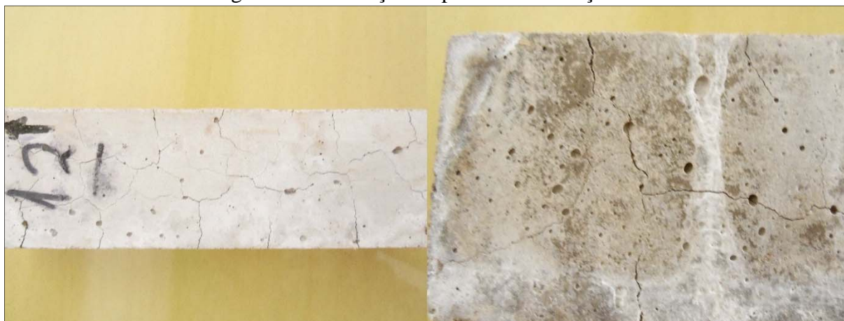
Figura 95- Lixiviação do prisma na condição 4.
