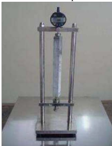
Figura 20- Leitura do comprimento da barra.
