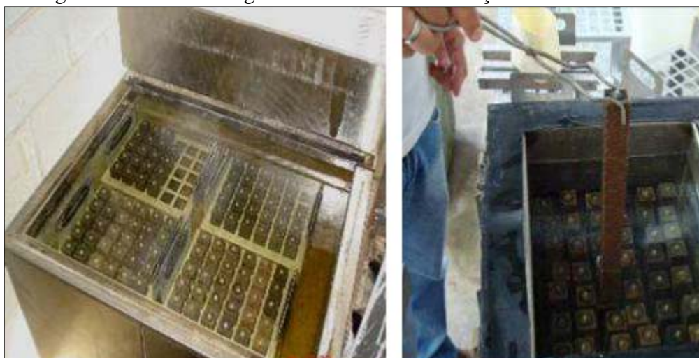
Figura 21- Barras de argamassa mantidas em solução de NaOH a 80°C.
