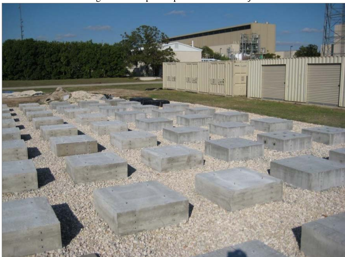
Figura 27- Corpos de prova simulando lajes.
