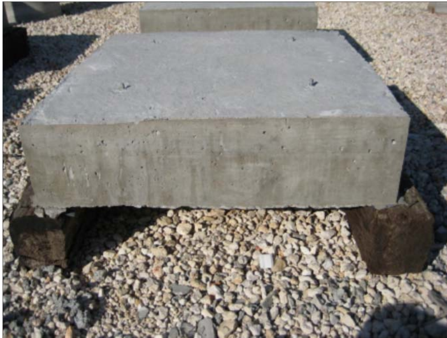
Figura 29- Corpos de prova simulando pavimentos de concreto em pontes.
