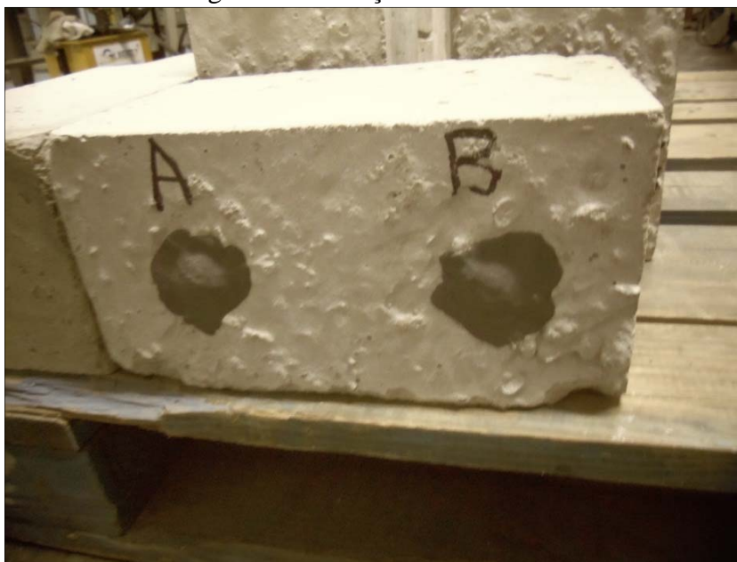
Figura 80- Vedação dos orifícios.
