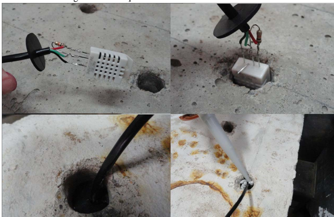
Figura 76- Inserção e selamento do sensor no orifício.
