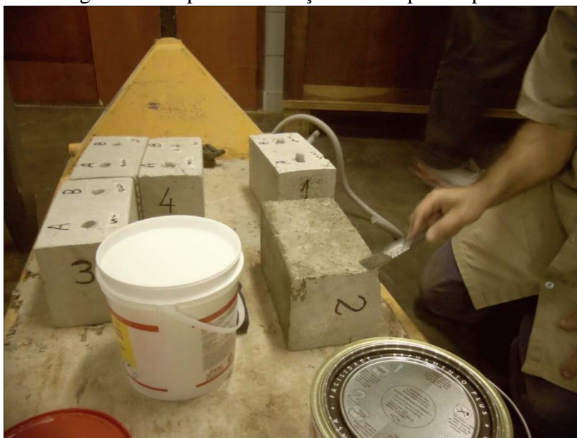
Figura 79- Impermeabilização dos corpos de prova.
