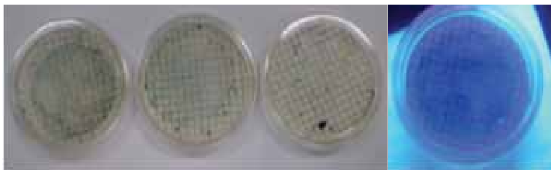
Figura 8. Teste de identificação e contagem de coliformes (Alfa kit), a) Mostrando crescimento de coliformes totais, b) Mostrando colônias fluorescentes correspondentes a coliformes fecais.
