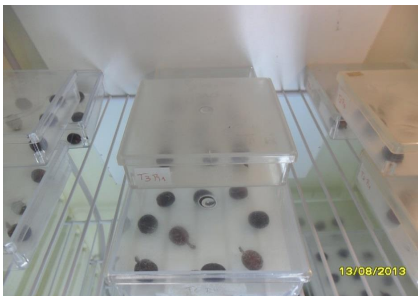
Figura 9. Método de plaqueamento com gerbox na avaliação microbiológica.
