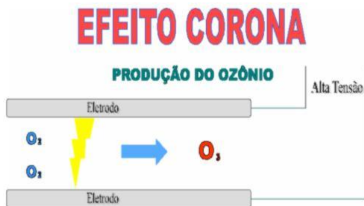
Figura 1. Esquema da produção de ozônio por efeito corona.
