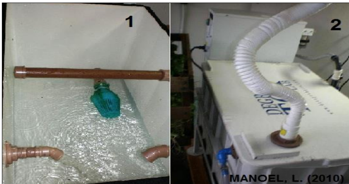
Figura 3. (1) Gerador de ozônio durante seu enchimento de água, com volume de 105 L. (2) Equipamento fechado durante a ozonização das amostras.
