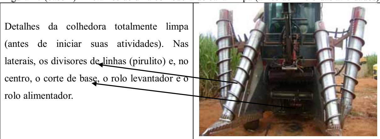
Figura 10 (caso 1) - Detalhes de uma colhedora de cana limpa (antes do início das atividades)
