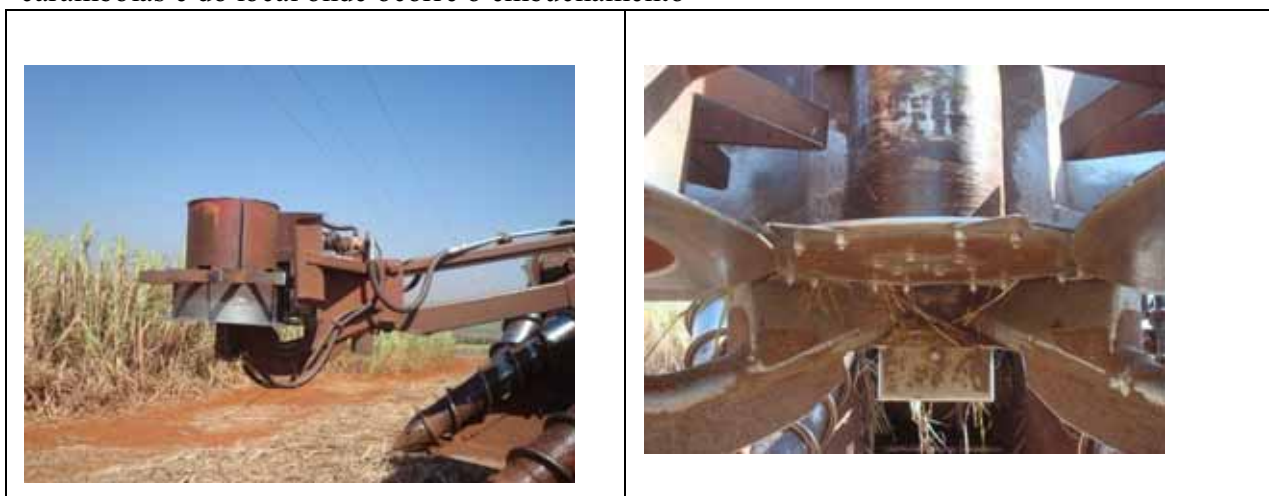
Figura 17 A e B (Caso 3) - Vista lateral do despontador da máquina e vista frontal das carambolas e do local onde ocorre o embuchamento
