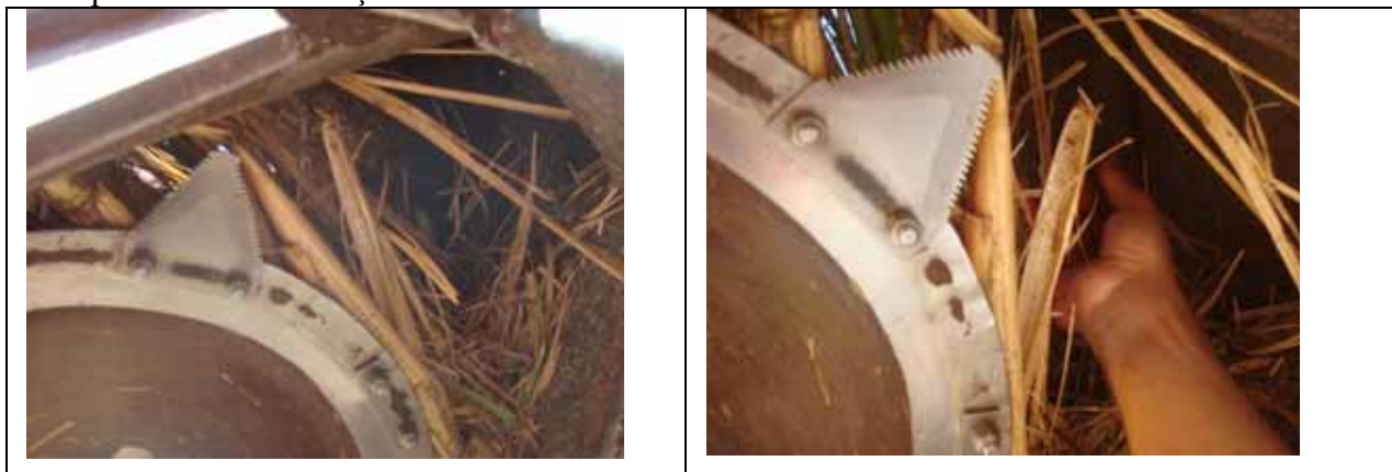
Figura 18 A e B (Caso 3) - Detalhe do local do embuchamento das carambolas do despontador com palha de cana-de-açúcar
