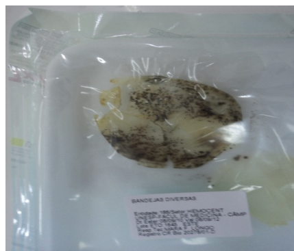
Figura 15 Fotografia de Quitogel com crescimento de fungos
