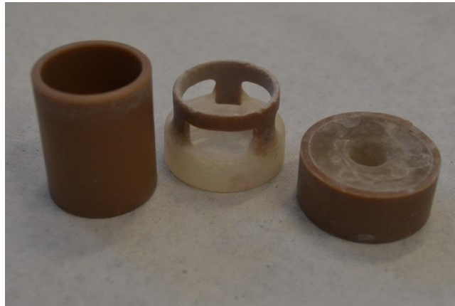
Figura 1 - Dispositivos para padronização do jateamento
