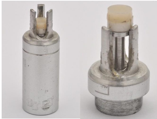
Figura 3 - Dispositivo de alinhamento para cimentação do disco de resina ao disco de zircônia
