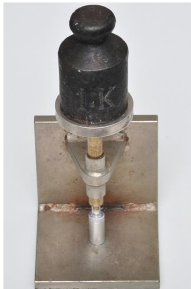
Figura 4 - Dispositivo para alinhamento da cimentação com carga de 1000 g.
