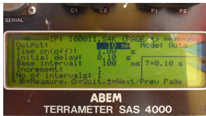
Figura 7.7: Detalhe da tela de configuração do modo IP do resistivímetro ABEM TERRAMETER SAS4000.
