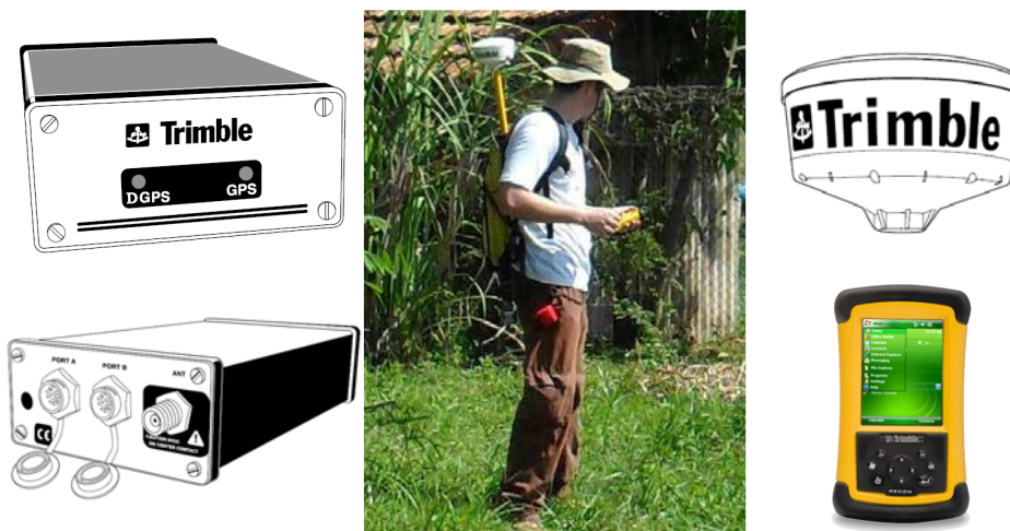
Figura 7.10: DGPS Trimble. À esquerda: receptor Navigation Pathfinder Pro XR 12 (painel frontal – acima – e painel traseiro – abaixo) (TRIMBLE, 2001, p.40 e 42). Ao centro: em operação no campo. À direita, acima: antena integrada GPS/MSK beacon (TRIMBLE, 2001, p.11). À direita, abaixo: coletor Recon ( http://www.trimble.com ).
