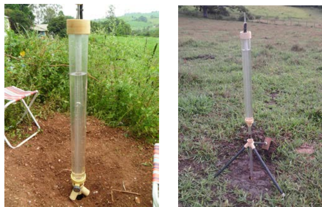
Figura 7.2: Permeâmetro Guelph 2800K1. À esquerda: Área 1. À direita: Área 2.
