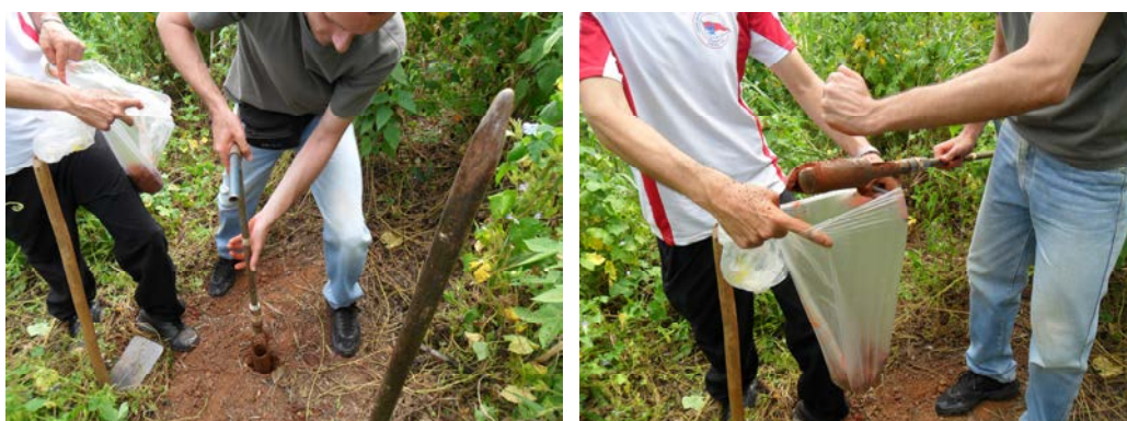
Figura 7.3: Coleta de amostras de solo do fundo dos furos dos ensaios de condutividade hidráulica na Área 1.
