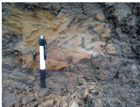
Figura 9.3: Afloramentos observados próximos à Área 2. À esquerda: sedimentos arenosos da Fm. Pirambóia. À direita: sedimentos silto-argilosos da Fm. Corumbataí.
