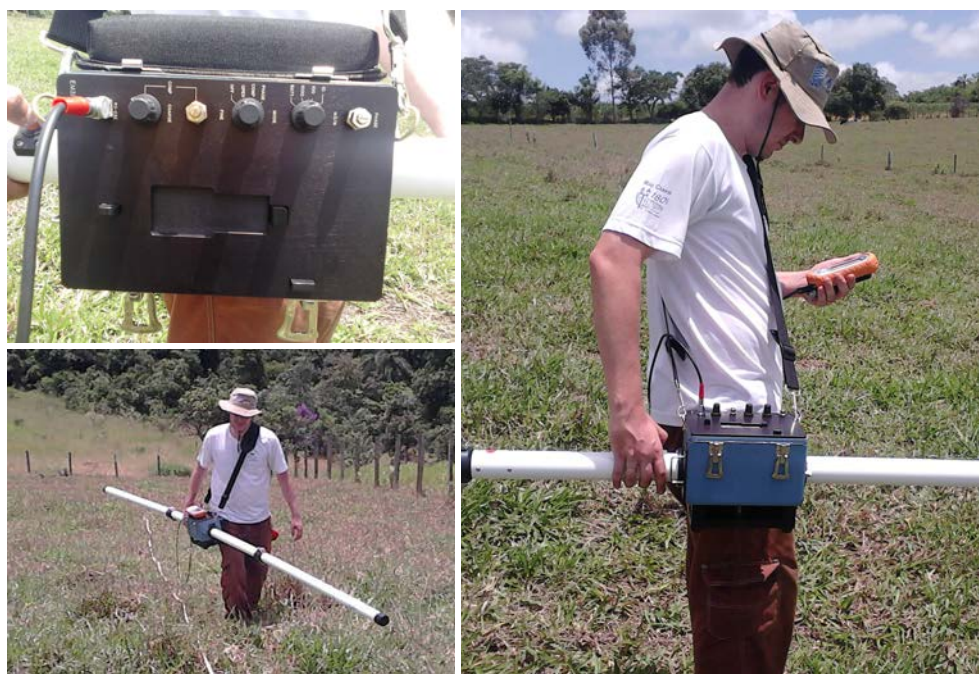
Figura 7.8: Condutímetro GEONICS EM31-MK2. À esquerda, acima: painel de controle. À esquerda, abaixo: em operação no campo. À direita: é possível visualizar o data logger na mão do operador.
