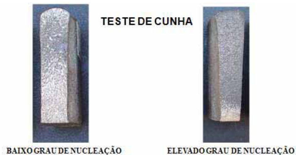
Figura 15 – fotos de fraturas de ferro fundido cinzento com baixo grau de nucleação e elevado grau de nucleação.
