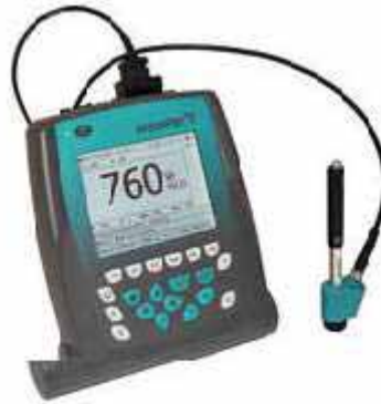
Figura 28 – Aparelho Equotip utilizado para medição de dureza Equotip.
