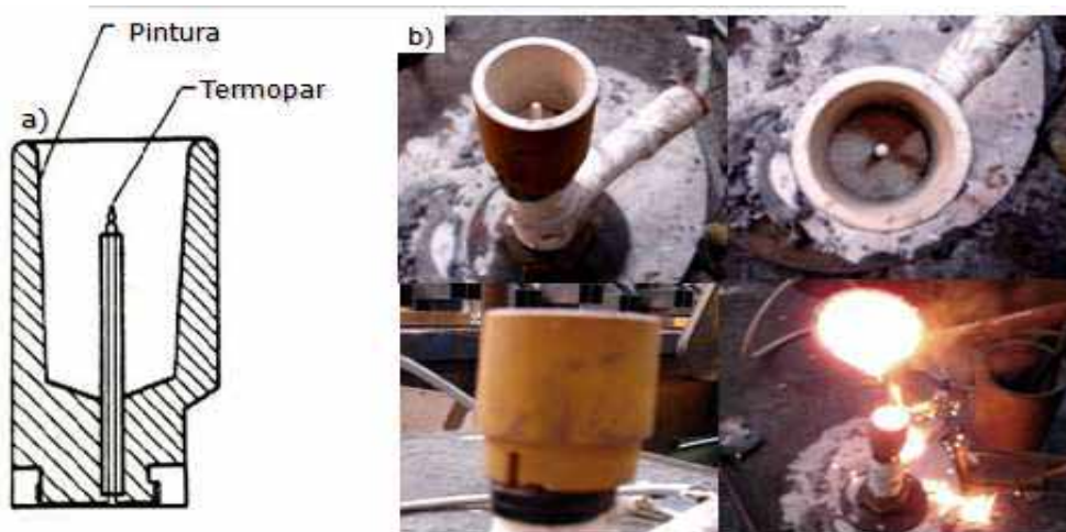
a) Seção do cadinho b) Fotos do cadinho em utilização
