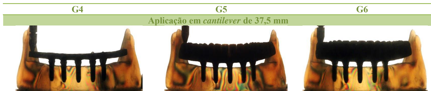
Figura 7 - Aplicação de cargas axiais nos grupos com Mini-Pilar (G4, G5 e G6)
