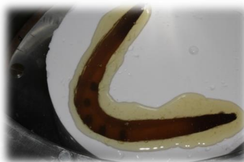
Figura 16 - Vazamento da resina fotoelástica PL-2
