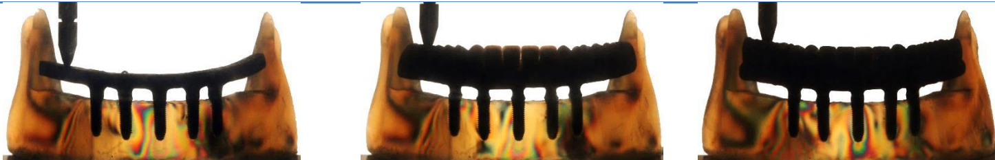
Figura 3: Aplicação de carga em cantilever de 20 mm para o grupo com o uso de UCLA, mostrando a diferença entre os materiais de revestimento.
