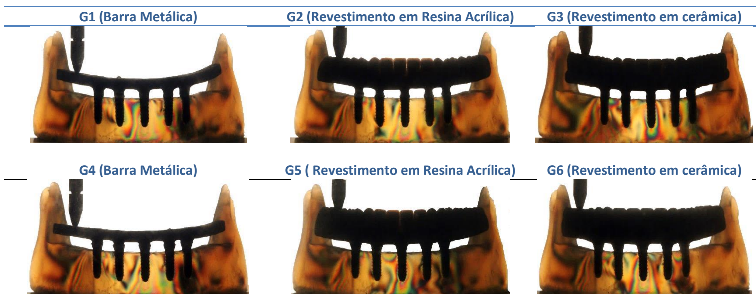
Figura 4: Aplicação de carga em cantilever de 20 mm para os grupos com o uso de UCLA (G1, G2, G3) e de intermediário (G4, G5, G6)
