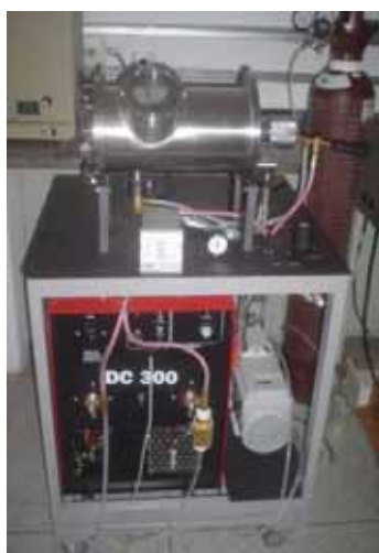
Figura 29 - Forno de fusão usado para a preparação das amostras das ligas de titânio utilizadas neste trabalho.
