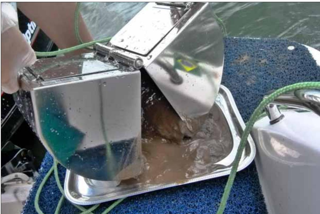
**Figura 8: Coleta de sedimentos utilizando a draga de Van Veene.**
