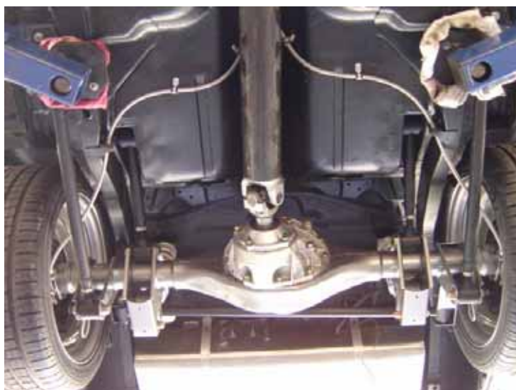
Figura 2 – Aplicação de eixo de transmissão em compósito em carros
