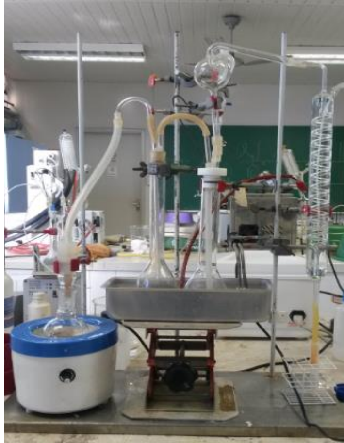
Figura 22- Aparato instrumental de destilação empregado para a desidratação do etanol
