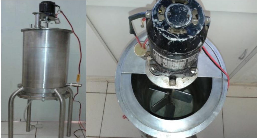
Figura 14- Reator para hidrólise equipado com aquecedor e agitador.
