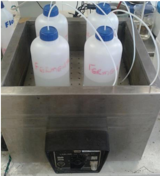
Figura 19- Aparato empregado no processo de fermentação e vinho obtido após a fermentação
