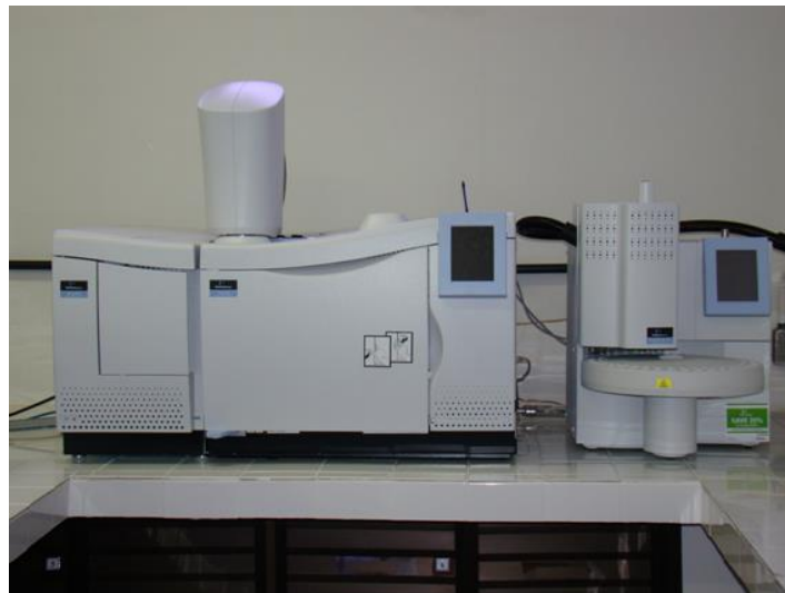
Figura 17- Sistema de cromatografia gasosa equipado com headspace .
