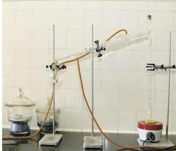
Figura 21- Aparato instrumental de destilação fracionado empregado na destilação do álcool da manga
