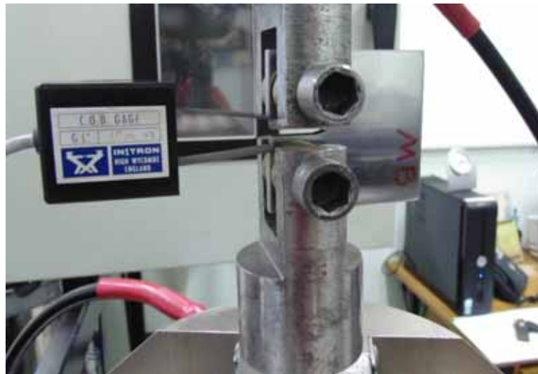
Figura 48 - Extensômetro acoplado ao entalhe do corpo de prova C(T).
