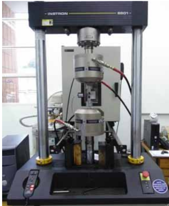
Figura 50 - Máquina universal de ensaios (servo-hidráulica) de modelo INSTRON 8801.
