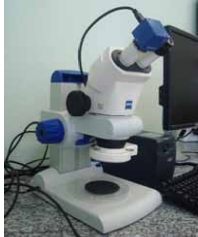
Figura 44- Estereoscópio ZEISS modelo STEMI 2000 com ampliação de até 50X.
