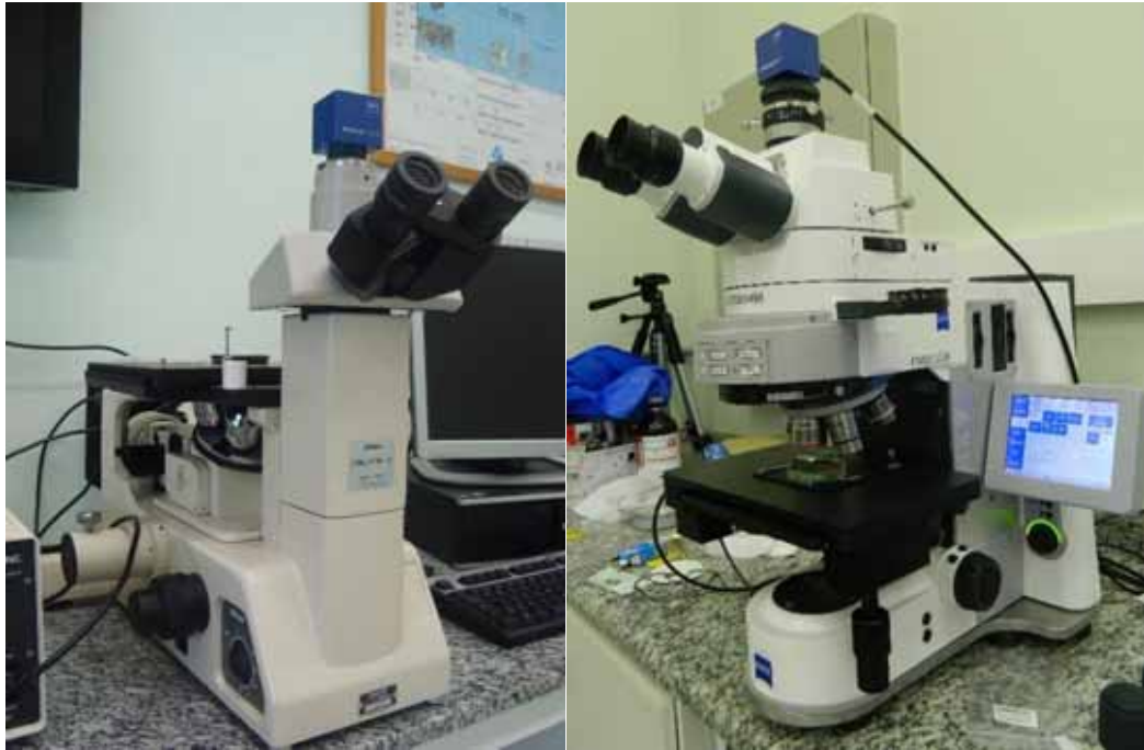
Figura 43- Microscópio óptico: (a) Epiphot 200; (b) motorizado Zeiss AxioImager Z2m.
