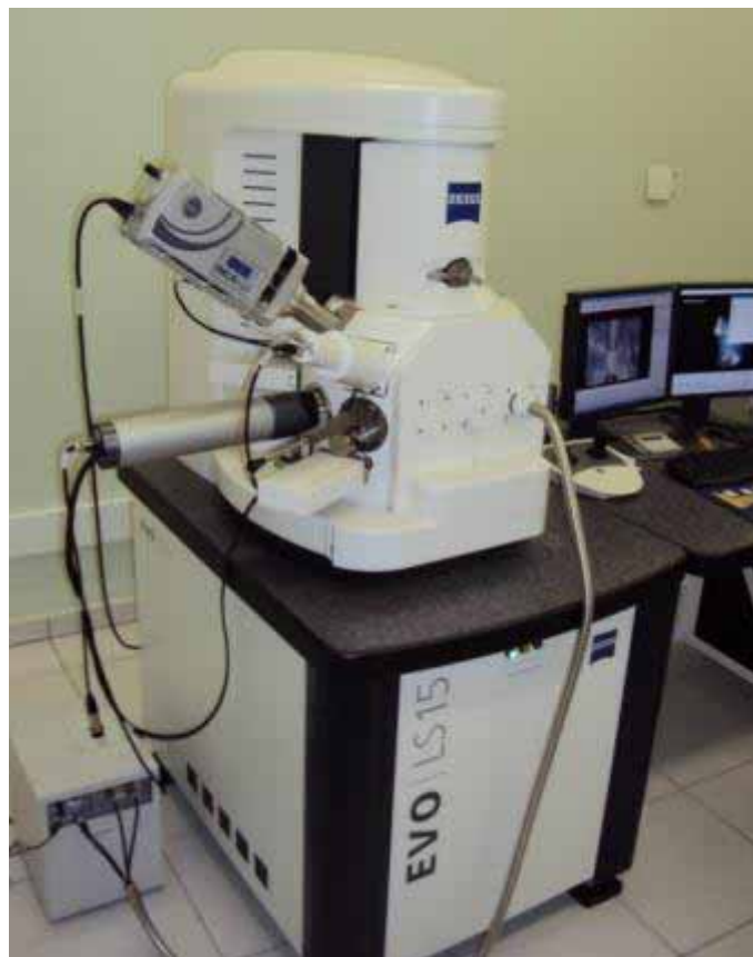
Figura 52 - Microscópio eletrônico de varredura utilizado na análise fractográfica.
