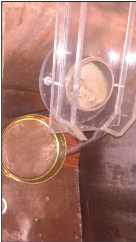
Figura 60 - Detalhe do ensaio de Inderbitzen em andamento: solo sendo carregado para peneira
