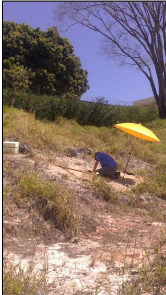
Figura 46 - Retirada de amostras deformadas
