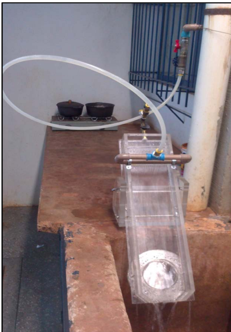
Figura 65 - Ensaio para calibração do Inderbitzen
