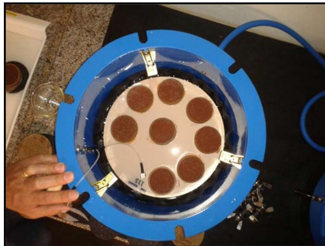
Figura 55 - Corpos de prova inseridos na câmara de pressão
