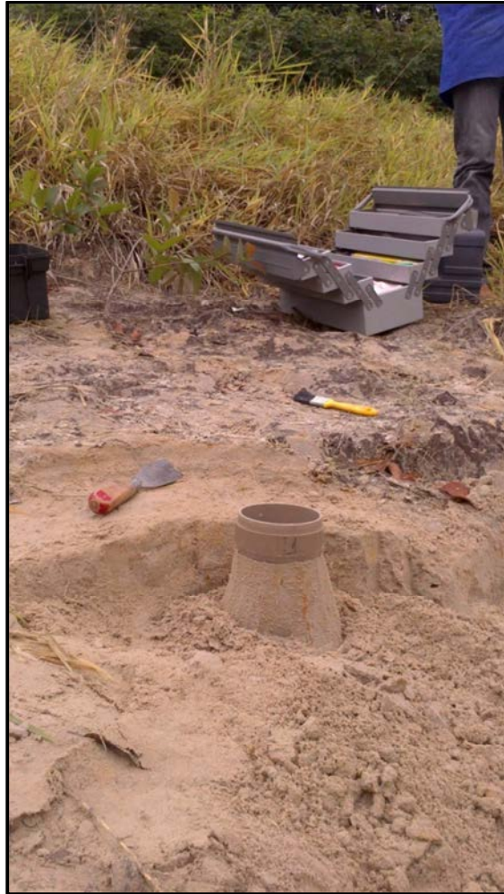
Figura 48 - Retirada de amostras indeformadas para ensaio de erodibilidade
