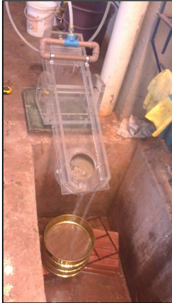
Figura 59 - Ensaio de Inderbitzen em andamento
