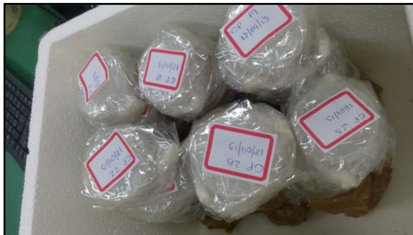
Figura 53 - Corpos de prova armazenados em caixa térmica de isopor
