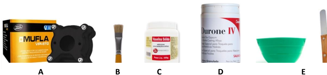
Figura 5: Materiais utilizados para vazamento do gesso no interior da mufla. A) Mufla para micro-ondas. B) Pincel. C) Vaselina Sólida. D) Gesso especial Durone tipo IV. E) Grau e espátula para gesso.
