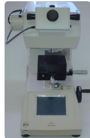
Figura 10: A) Espectrofotômetro de Reflexão Ultravioleta UV-2450 para realização do teste de estabilidade de cor. B) Microdurômetro modelo HMV-2T para teste de microdureza.
