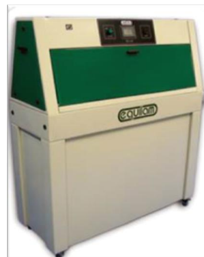
Figura 11: A) Máquina de Ensaio Universal EMIC utilizada para o teste de resistência à flexão. B) Câmara de Envelhecimento Acelerado.
