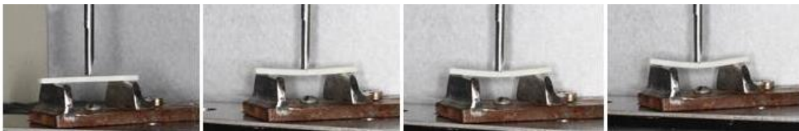
Figura 24: Realização do teste de resistência à flexão, demonstrando a amostra se flexionando até o momento de sua fratura.
