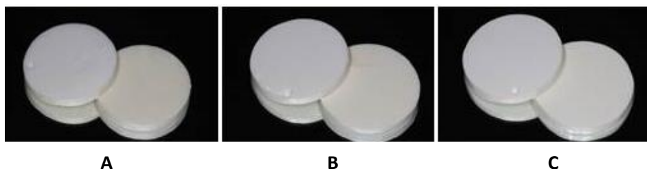
Figura 19: Amostras circulares utilizadas nos testes de cor e microdureza. Amostra superior: antes do envelhecimento. Amostra inferior: após envelhecimento. A) Grupo TiO 2 1%. B) TiO 2 2% e C) TiO 2 2,5%.
