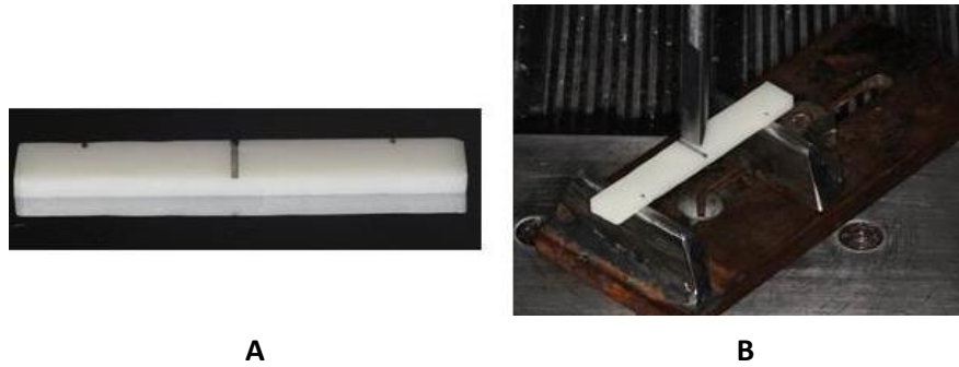
Figura 23: A) Marcações realizadas nas amostras para teste de resistência à flexão (marcação no centro da amostra e duas marcações distantes 1 cm das extremidades). B) Amostra devidamente posicionada no dispositivo para realização do teste por meio da técnica dos 3 pontos.
