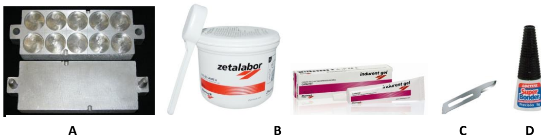
Figura 4: Materiais utilizados na confecção dos discos de silicone para confecção do molde das amostras de resina acrílica para os testes de cor e microdureza. A) Matriz metálica com dimensões de 30mm x 3mm , contendo 10 orifícios circulares. B) Kit de silicone de condensação de uso laboratorial (colher de medida, Indurent Gel e Zetalabor. C) Lâmina de bisturi nº 15. D) Super Bonder para colagem dos discos na base de gesso.
