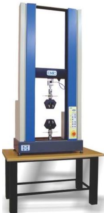
Figura 11: A) Máquina de Ensaio Universal EMIC utilizada para o teste de resistência à flexão. B) Câmara de Envelhecimento Acelerado.
