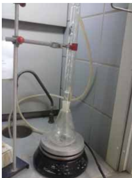
Figura 8: Sistema de refluxo utilizado nas sínteses.
