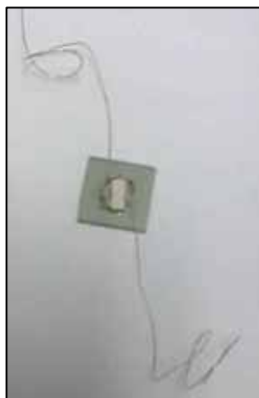
Figura 13: Amostra P500 preparada para ser submetida à caracterização elétrica.
