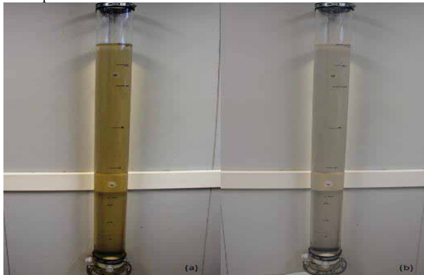
Figura 5.6: Efluente antes da ozonização (a) e após a ozonização (b) para a dose de 10,00 \text{ mg O}_3 \text{ L}^{-1} e tempo de contato de 5 min.
