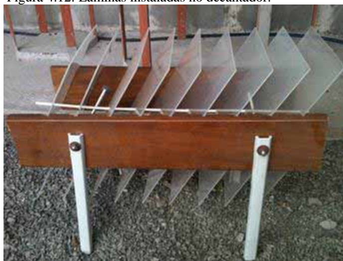
Figura 4.12: Lâminas instaladas no decantador.
