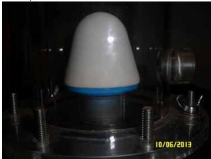
Figura 4.19: Difusor microporoso instalado na base coluna de ozonização.
