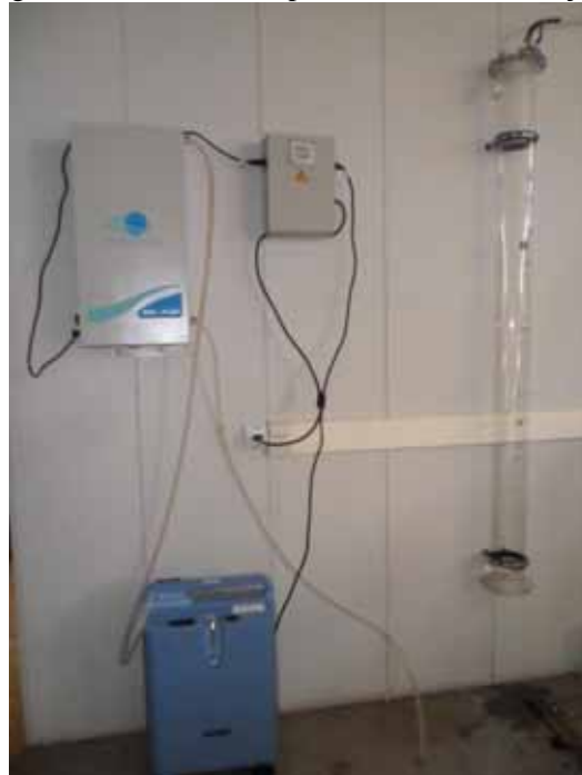
Figura 4.14: Unidade experimental de ozonização.
