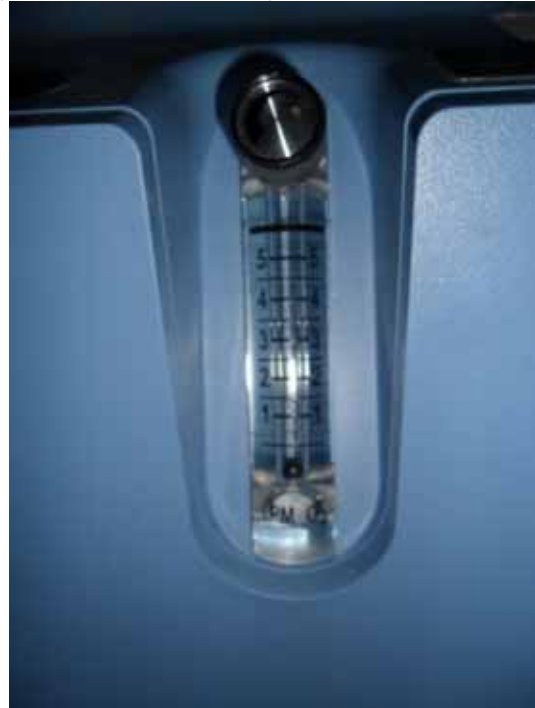
Figura 4.16: Rotâmetro regulador da vazão de oxigênio.
