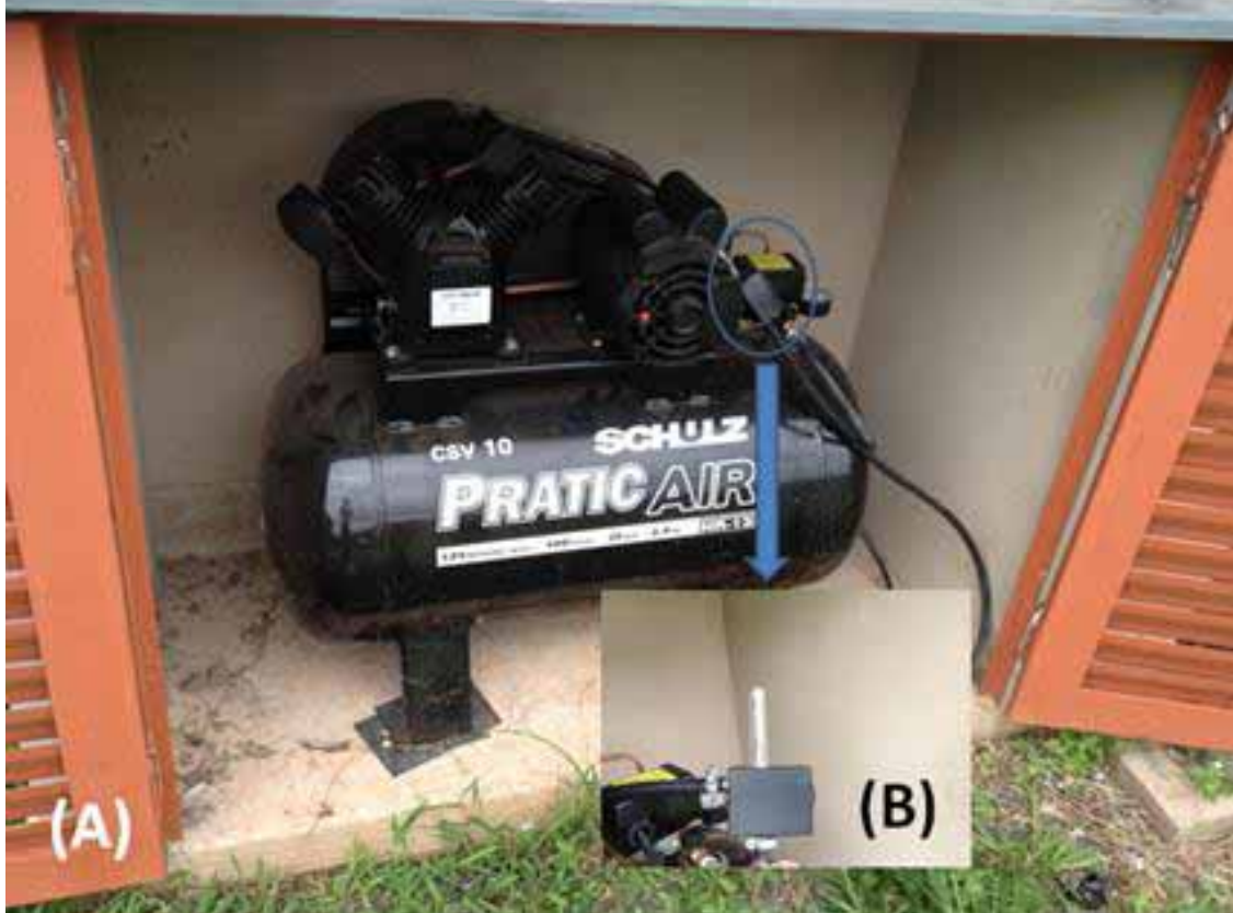
Figura 4.9: (A) Vista frontal do compressor de ar. (B) Rotômetro utilizado para controle de vazão.
