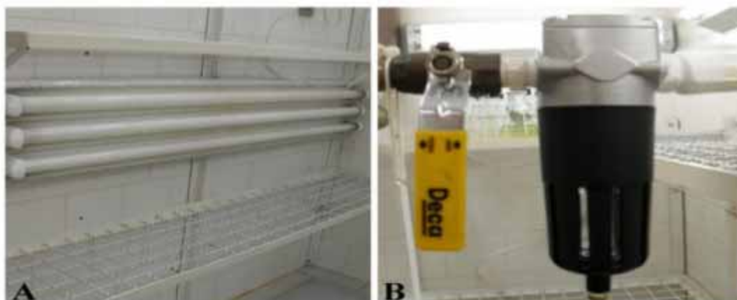
FIGURA 3 - Sistema de iluminação artificial composto por lâmpadas fluorescentes e prateleiras de estrutura vazada (A) e filtros interno de ar (B)
