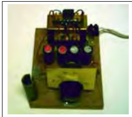
Figura 3.3. Circuito eletrônico onde conectou-se cada conjunto transistor e dissipador.
