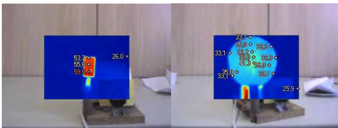
Figura 4.15. Imagem termográfica da superfície do alumínio usado como dissipador de calor.
