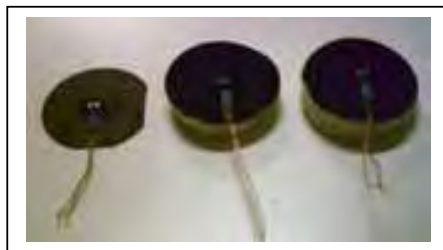
Figura 3.4. Dissipadores na forma redonda: diamante CVD, cobre e alumínio
