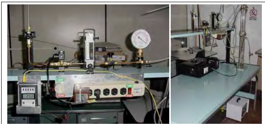
Figura 3.2. Reator de filamento quente com os periféricos: fonte de corrente ajustável, medidores de vazão, pressão e temperatura.
