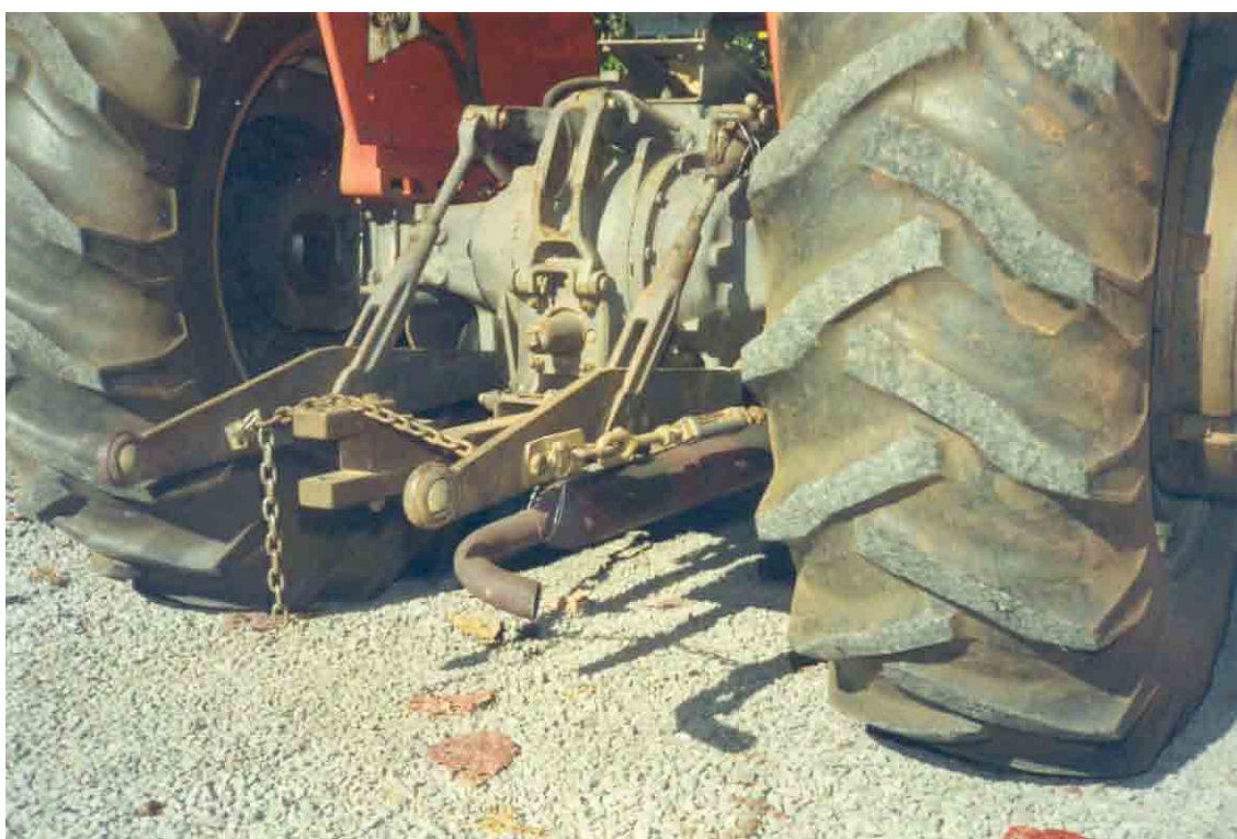
Fig. 5.2 - Posição da câmara de expansão no final da tubulação de descarga.
