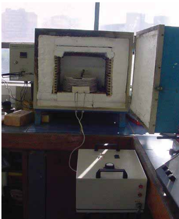
Figura 13 - Forno de Recozimento com Indução Magnética (MOZETEIC, 2008)
