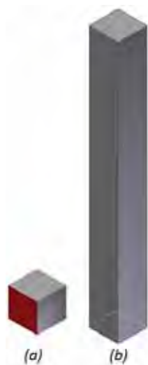
Figura 21 - (a) Amostra para metalografia, com destaque em vermelho para a face analisada (b) Amostra para ensaio magnético. (ADRIANO, 2012)
