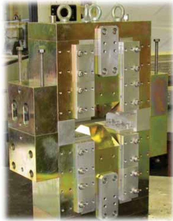
Figura 5 - Protótipo de um Dipolo Magnético construído com Imãs Permanentes (ADRIANO, 2012)
