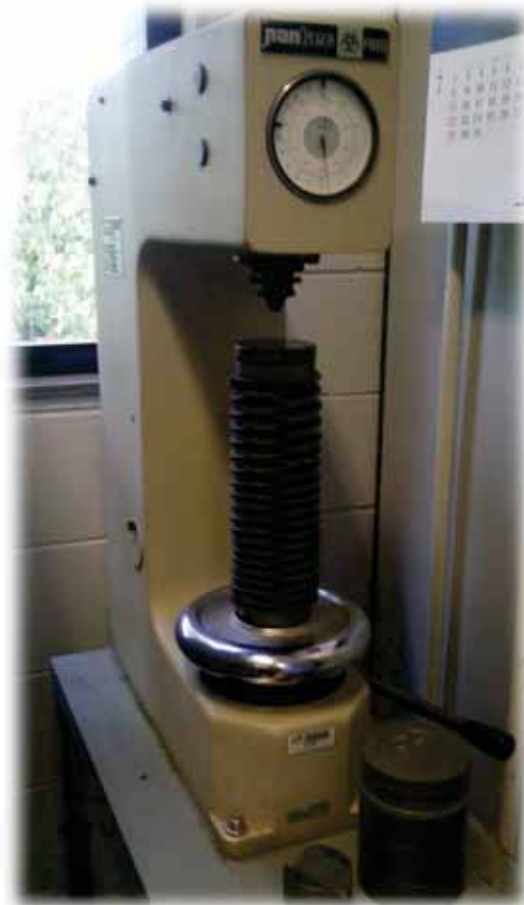
Figura 26 - Durômetro PANTEC Ltda. Utilizado nas medidas de dureza (ADRIANO, 2012)
