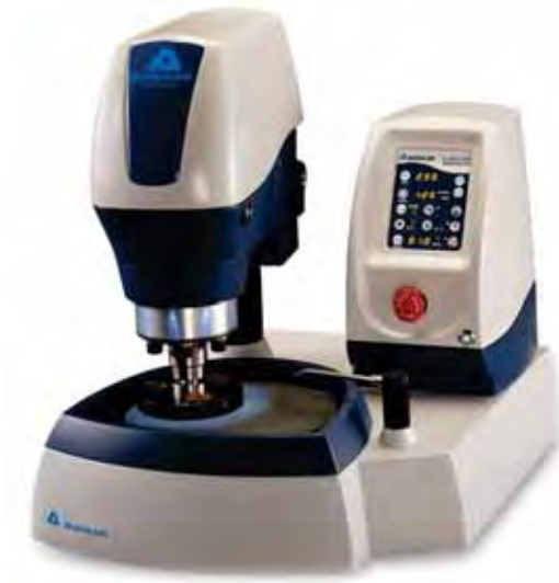
Figura 25 - Politriz automática utilizada na preparação das amostras para ensaio de EBSD (ADRIANO, 2012)
