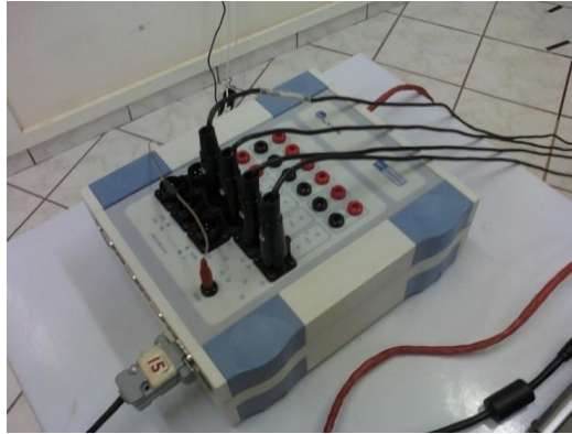
Figura 3. Módulo condicionador de sinais analógicos, modelo Bio EMG 1000, marca Lynx®, com os cabos dos eletrodos conectados.
