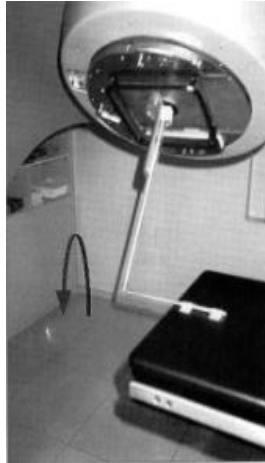
Figura 8 – Verificação da rotação do eixo do gantry [3] .
