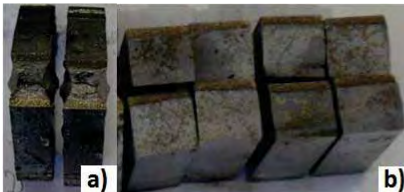
Figura 35 – Corpos de prova que não se romperam a) e os quais romperam apresentando características frágeis.
