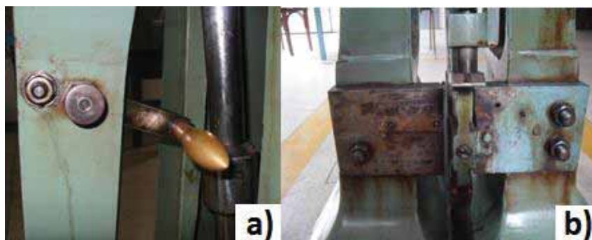
Figura 33 – Algumas funções da máquina Charpy: a) Trava de segurança b) Local onde os corpos de prova sofrem o impacto.
