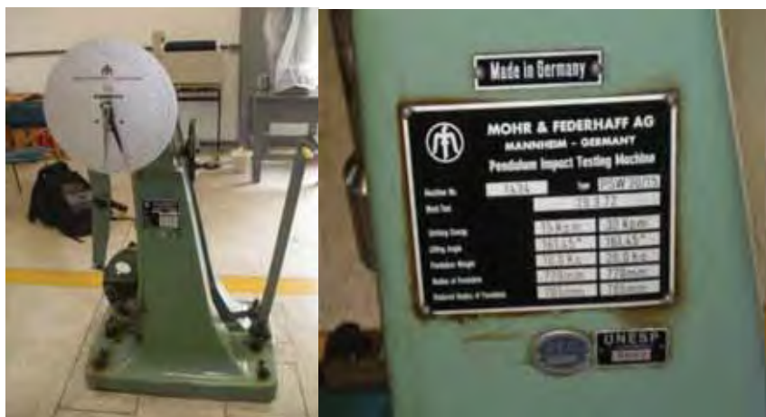
Figura 32 – Máquina realizada o ensaio Charpy-V e especificação da mesma.
