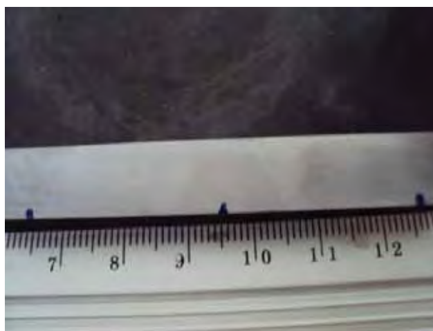
Figura 28 – Localização do entalhe, do risco central do entalhe 27,5 mm para ambos os lados.
