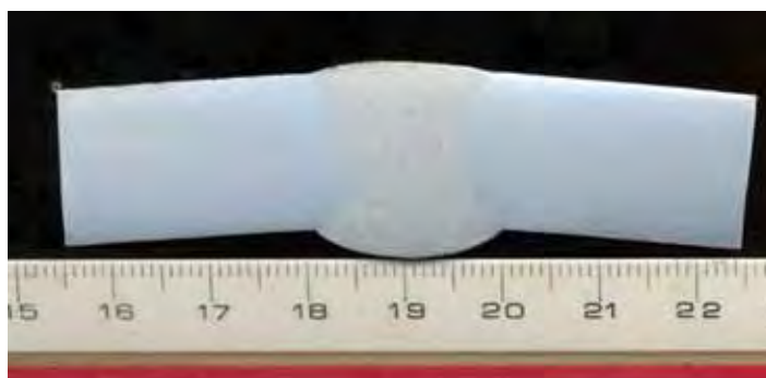
Figura 23 – Corpo de prova utilizado para análise metalográfica.
