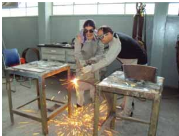
Figura 20 – Corte oxi-acetileno realizado no laboratório da UNESP – Guaratinguetá.
