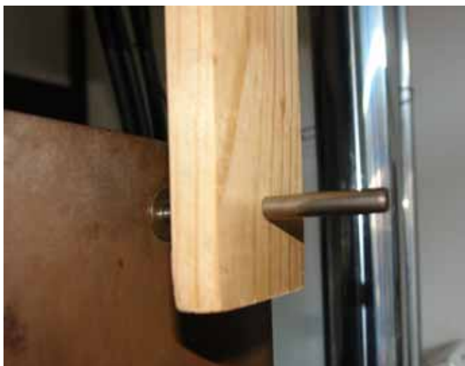
Figura 29: Pino metálico fixado no corpo de prova de Pinus oocarpa para o ensaio de embutimento.
