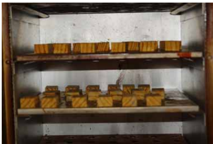
Figura 41: Corpos de prova de densidade e umidade na estufa.
