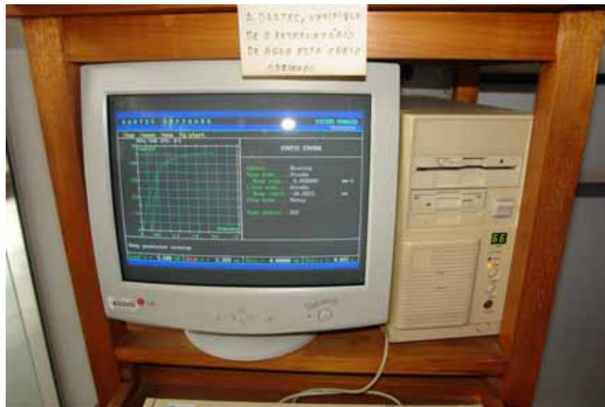
Figura 34: Visualização do gráfico força (kN) x stroke (mm) durante ensaio na máquina DARTEC.
