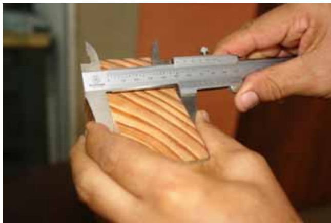
Figura 25: Medidas das dimensões dos corpos de prova com a utilização do paquímetro.
