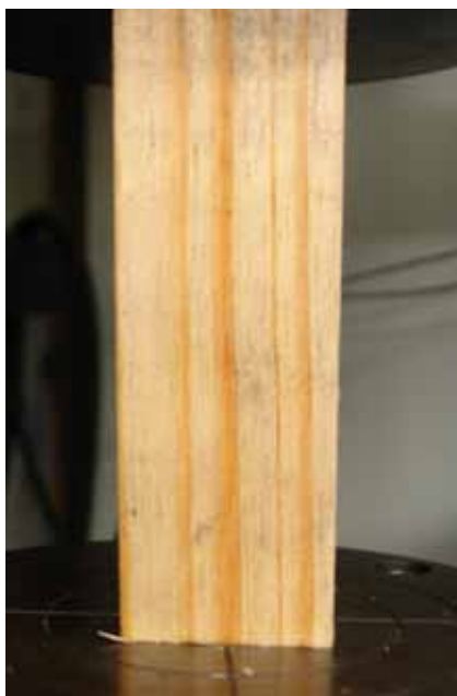
Figura 48: Ensaio de compressão paralela às fibras de Pinus taeda sem deformações consideráveis.
