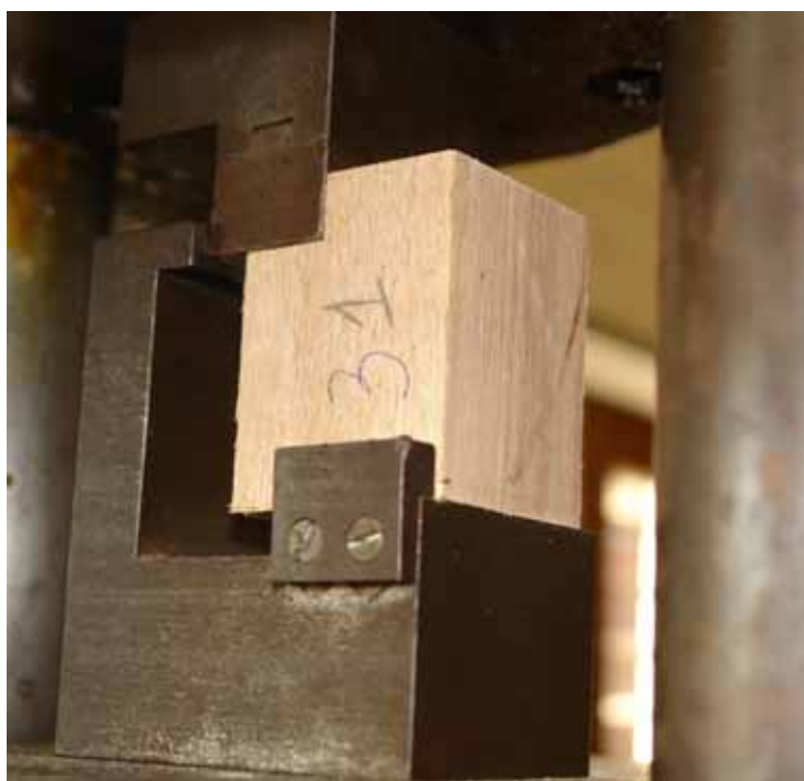
Figura 40: Corpo de prova de Eucalipto citriodora para ensaio de cisalhamento paralelo às fibras.
