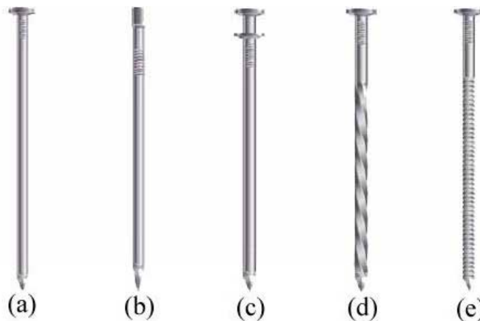
Figura 2: Tipos de pregos: (a) prego com uma cabeça (b) prego sem cabeça (c) prego com duas cabeças (d) prego ardox (e) prego anelar. Fonte: Duarte (2004).
