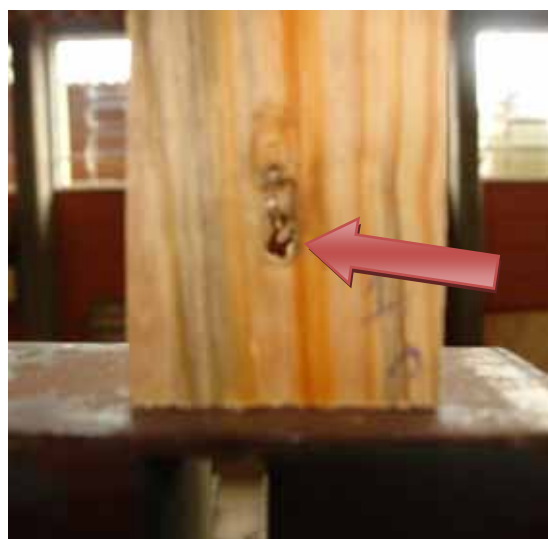
Figura 42: Esmagamento da madeira de Pinus taeda em ensaio de embutimento paralelo.
