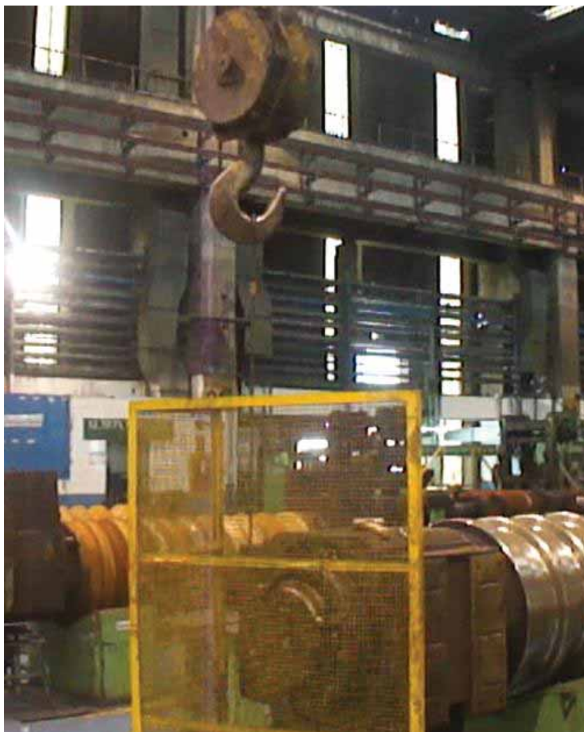
Figura 16 – Aperto da porca com o auxílio da ponte rolante (Fonte: GSP)
