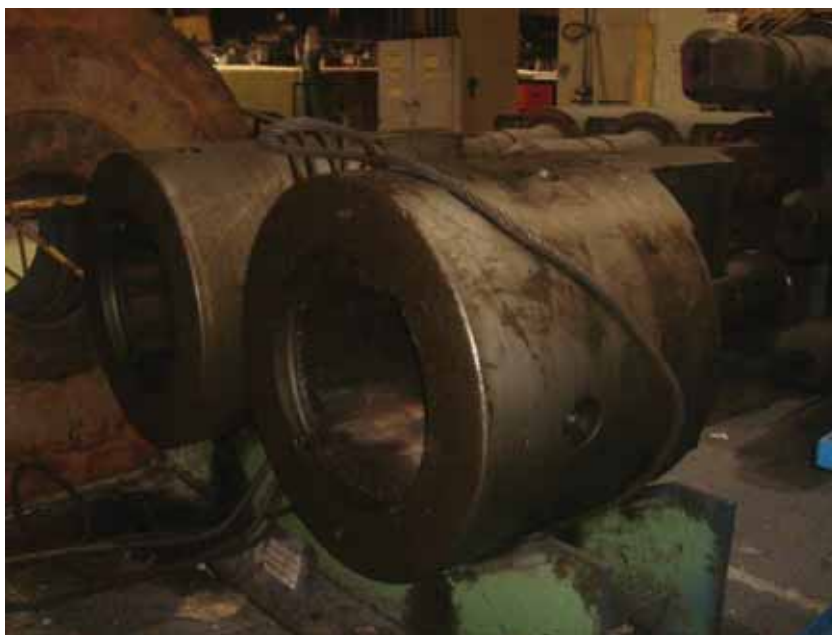
Figura 17 – Transporte do Wobbler com a utilização da ponte rolante (Fonte: GSP)
