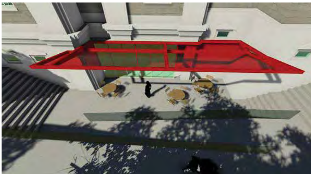
Figura 46: Cobertura metálica nos acessos laterais.
