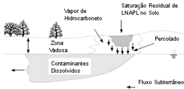
Figura V - 14: LNAPL retido em estado de saturação residual na zona não saturada. Fonte: Newell et al. – EPA.
