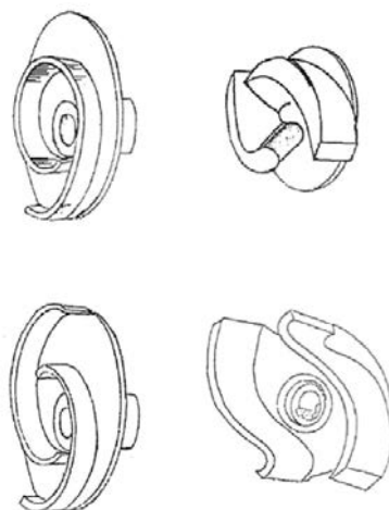
Figura 13 - Tipos de rotores semi-abertos
