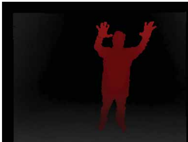
Figura 32: Mapa de profundidade gerado pelo Kinect.
