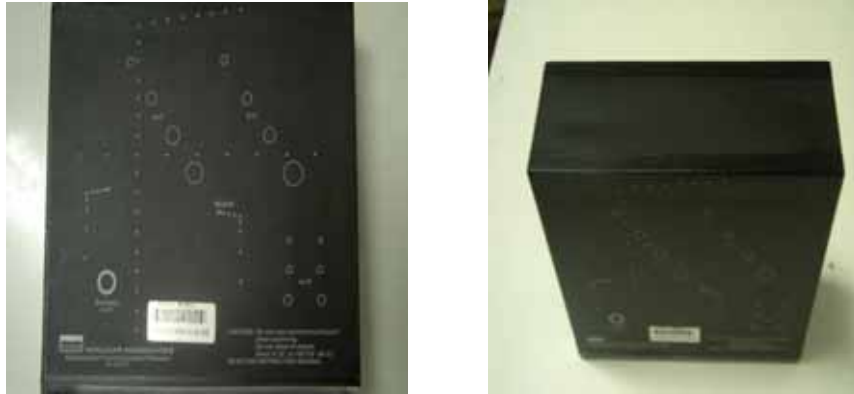
Figura 4: Objeto simulador para ultrassom Multipurpose Tissue/ Cyst Ultrasound Phantoms 84-317 and 84-317-7000 fabricado pela Nuclear Associates.
