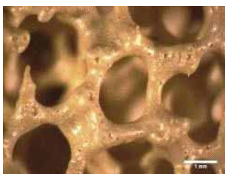
Figura 11: Peça de titânia de três deposições: a primeira de 45% em sólido e as posteriores com 45% em sólido mais 20% de amido de milho.
