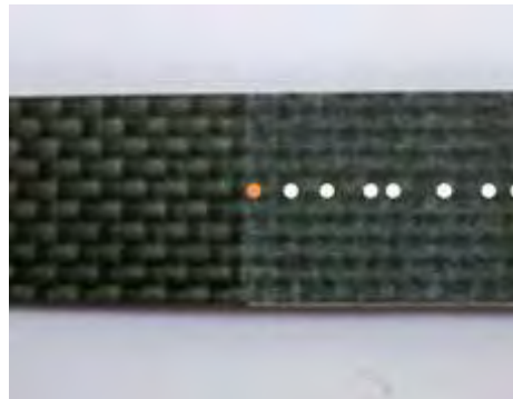
Figura 44: Pontos escolhidos ao longo da propagação da trinca
