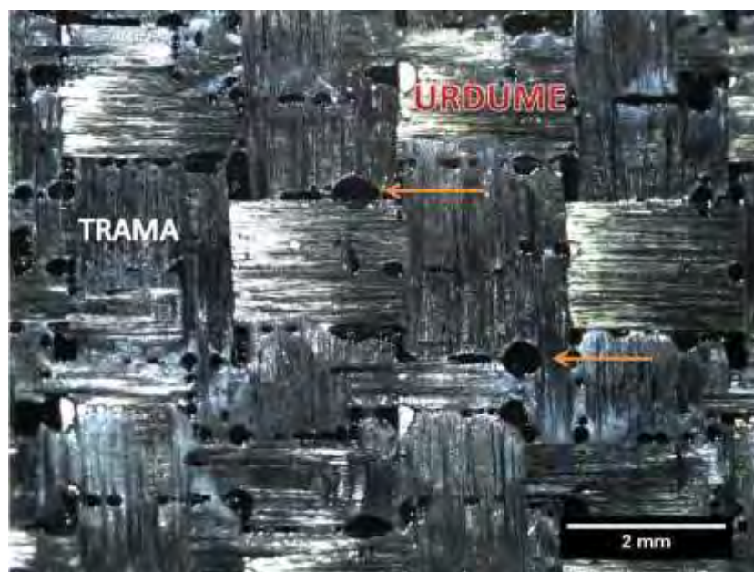
Figura 45: Superfície de fratura de um corpo de prova em condição natural
