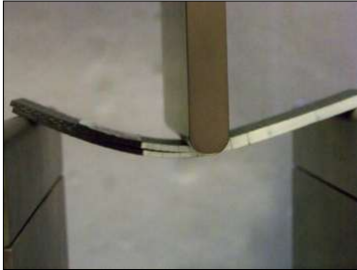
Figura 41: Amostra durante o ensaio ENF
