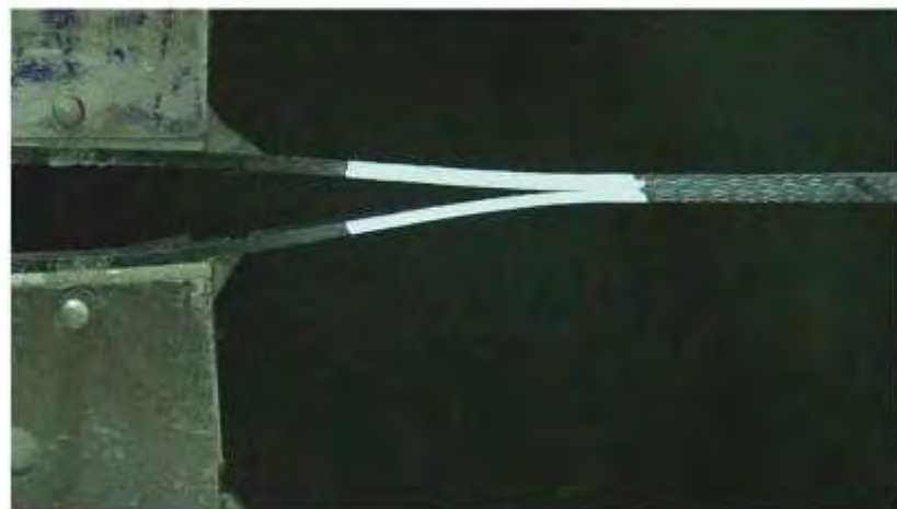
Figura 18 – Corpo de prova durante o ensaio, representando a propagação da trinca
