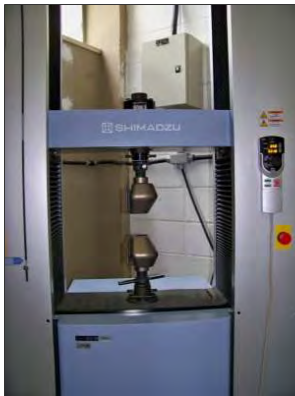
Figura 16 – Máquina utilizada para realização do ensaio DCB
