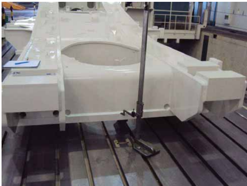
Figura 49 – Alinhamento do altímetro sobre a chapa base (230 mm)
