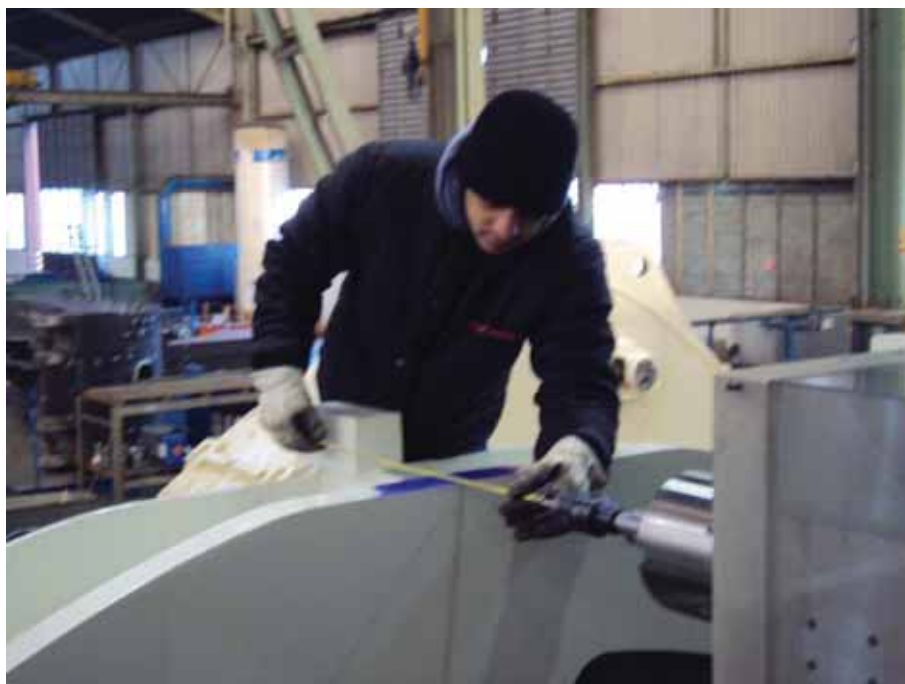
Figura 62 – Verificação dos alinhamentos em X e Z.
