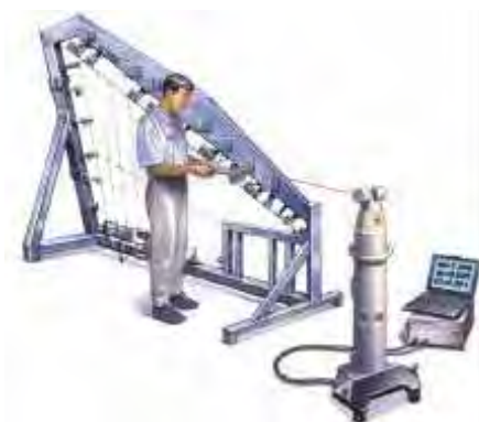
Figura 14 - Medição Manual com o IFM (CATÁLOGO LEICA, 1993).
