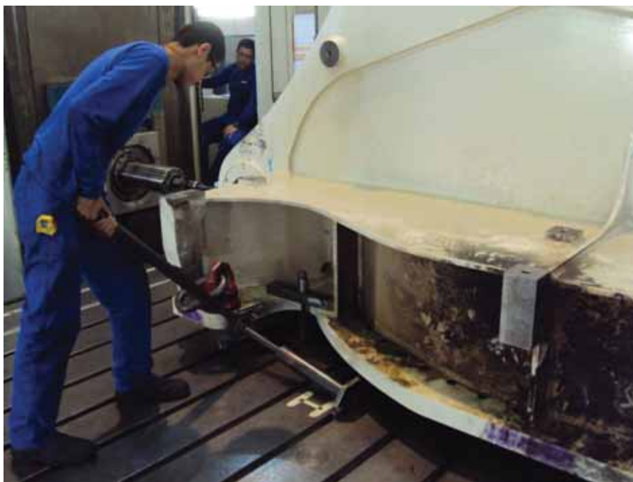
Figura 78 – Alinhamento para usinagem da Fase C
