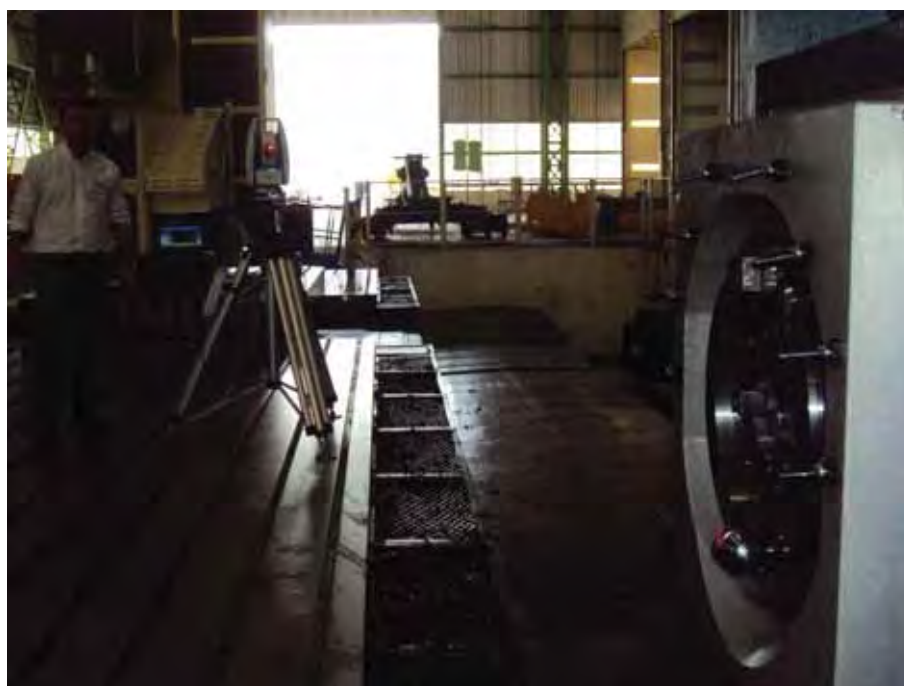
Figura 85 – Medição de um ponto no cabeçote da máquina
