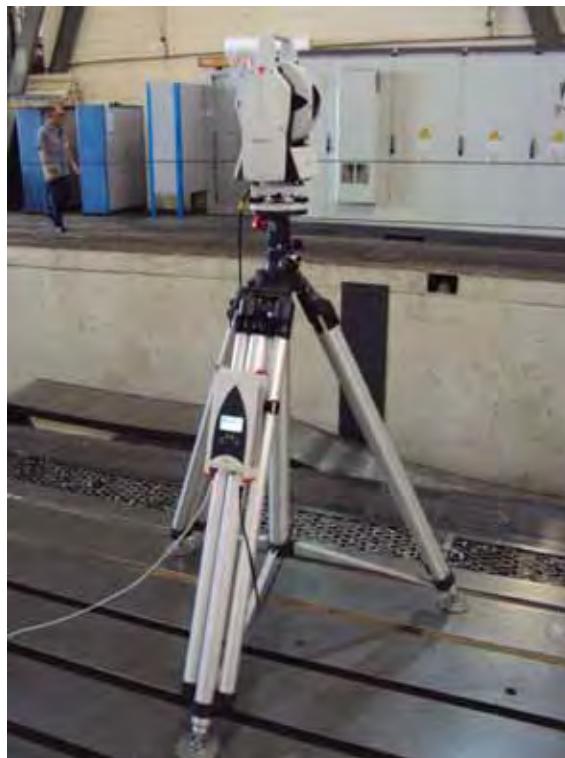
Figura 81 – Aparelho Laser tracker montado em seu tripé.
