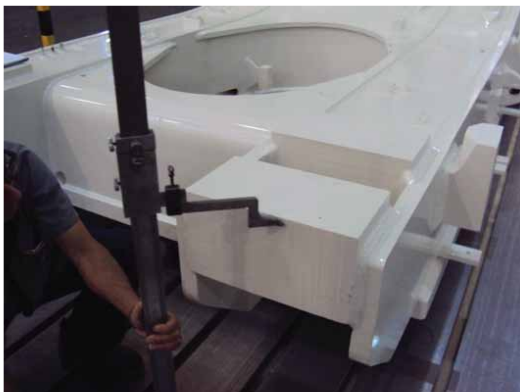
Figura 54 – Traçagem do local onde será realizada a usinagem
