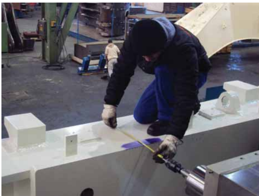
Figura 61 – Verificação dos alinhamentos em X e Z.
