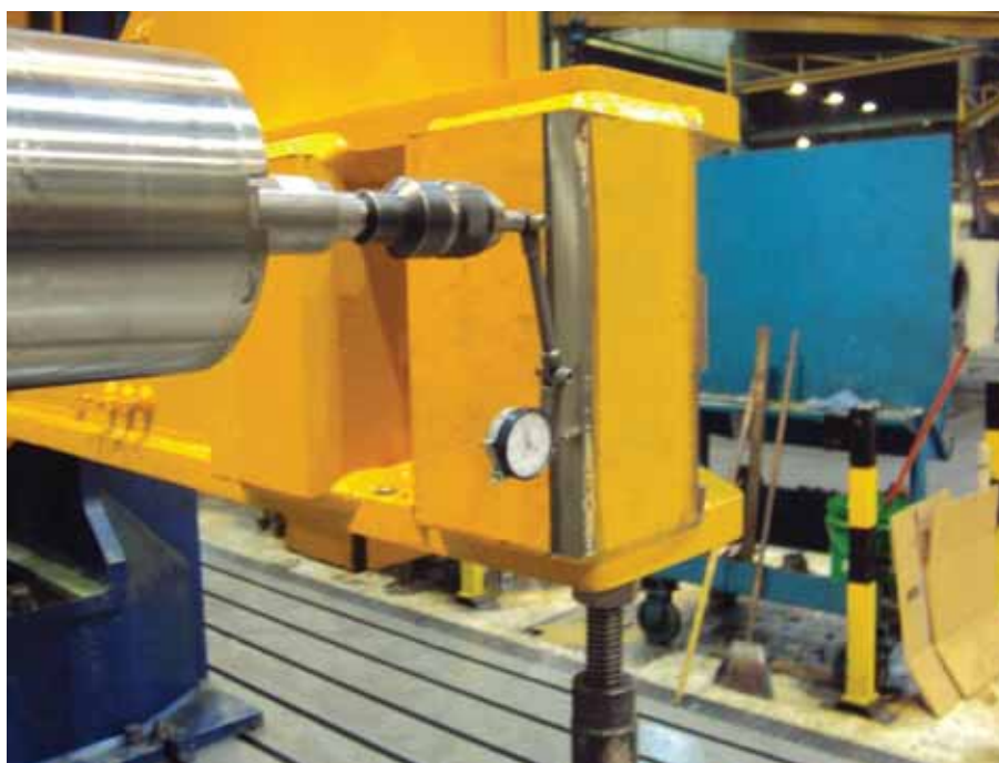
Figura 70 – Centragem e alinhamento Fase B
