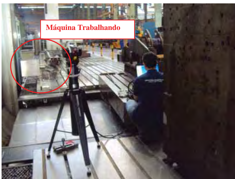
Figura 96 – Máquina trabalhando enquanto o laser tracker realiza o setup
