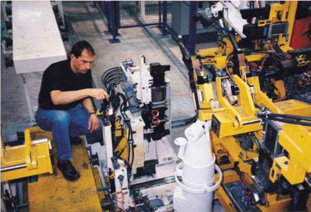
Figura 22 - Aferição de um dispositivo com o Laser tracker (VIEIRA, 2003).
