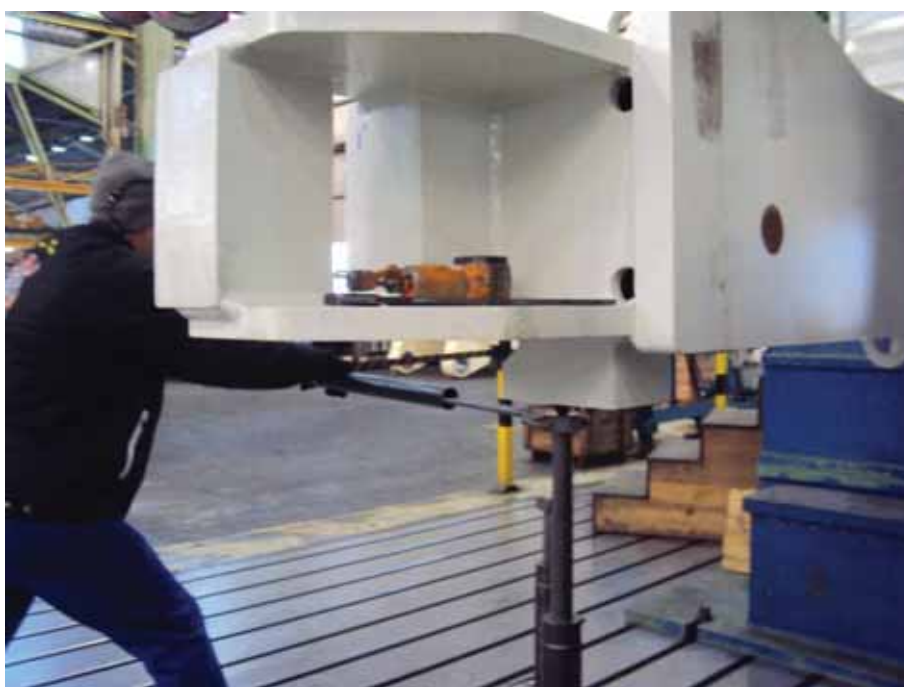
Figura 67 – Ajuste no calço para obter alinhamento
