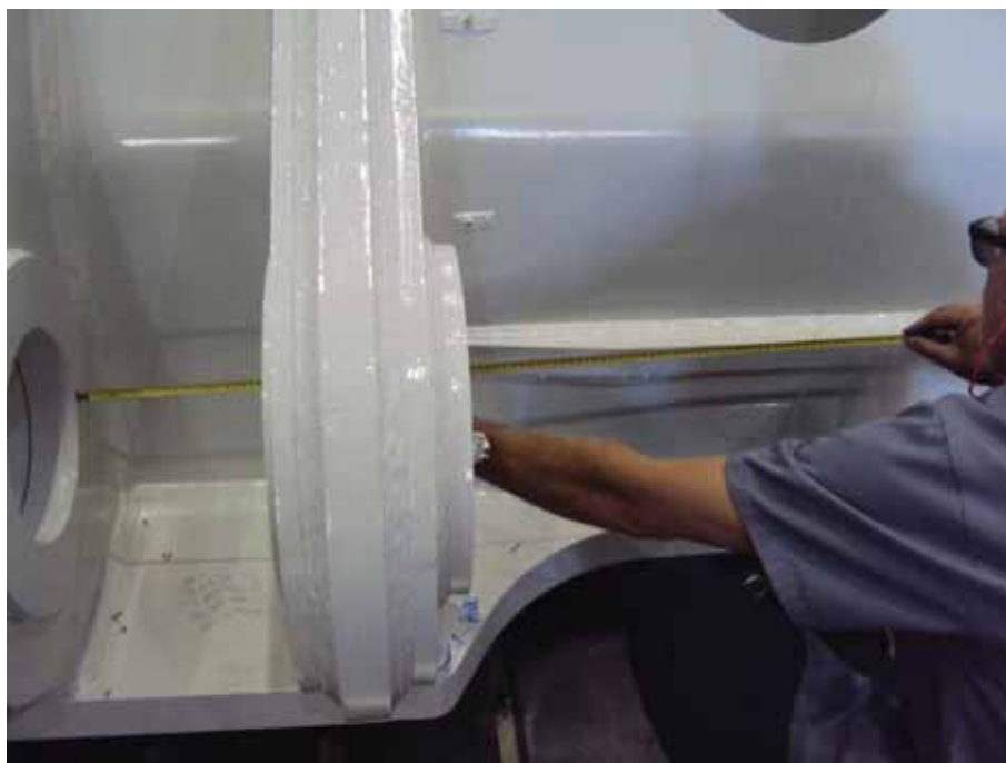
Figura 60 – Verificação dos diâmetros em relação à linha de centro da peça.
