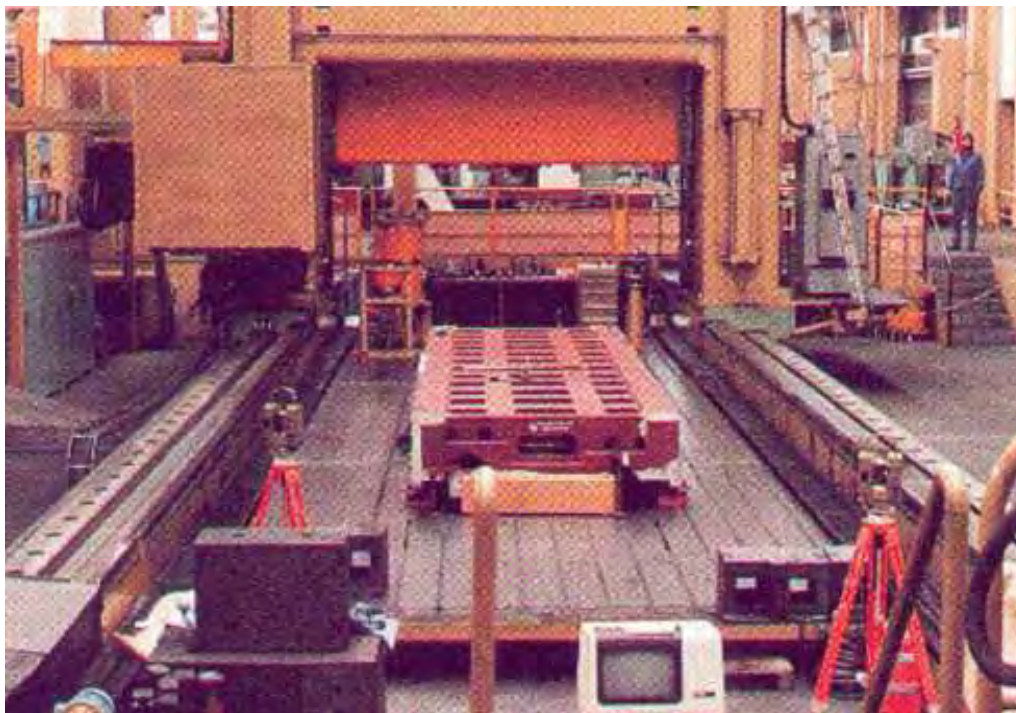
Figura 29 – Verificação geométrica de máquinas de usinagem (VIEIRA, 2003).
