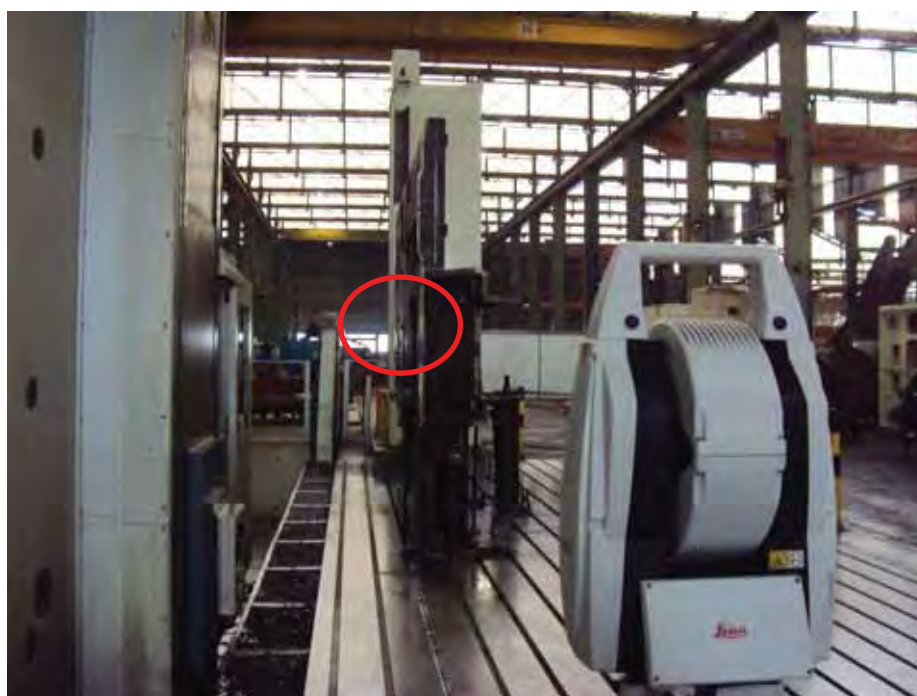
Figura 87 – Medição de um dos 4 pontos na coroa da peça
