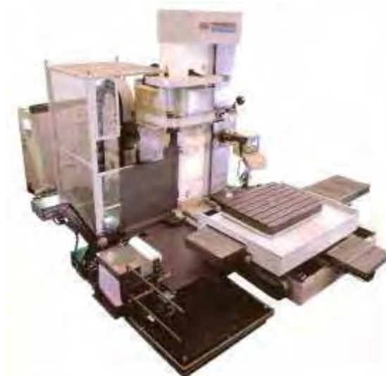
Figura 01 - Esquema de mandriladora universal horizontal (RIBEIRO, 2008).
