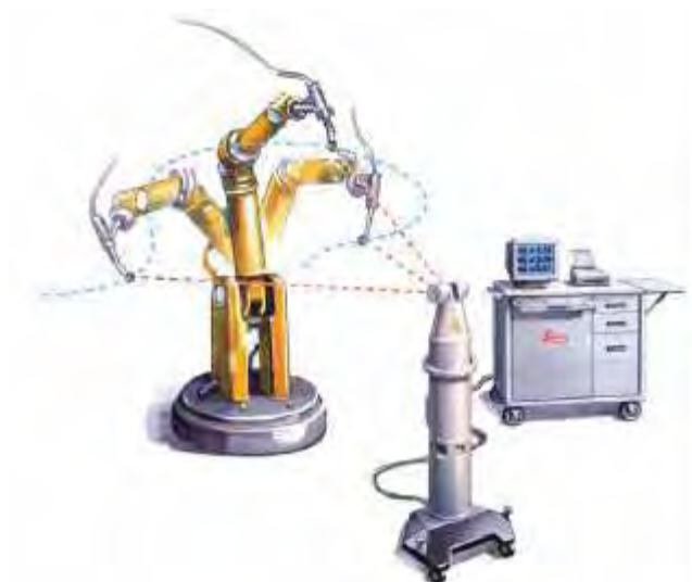
Figura 19 - Ilustração da calibração de robôs (CATÁLOGO LEICA, 1993).
