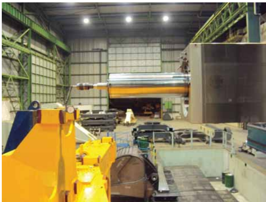
Figura 72 – Centragem e alinhamento Fase B
