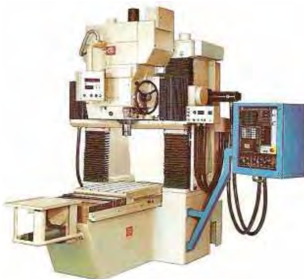
Figura 02 - Esquema de mandriladora universal vertical (RIBEIRO, 2008).
