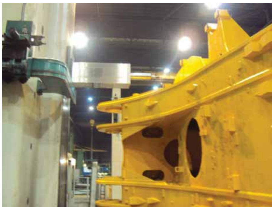
Figura 71 – Centragem e alinhamento Fase B
