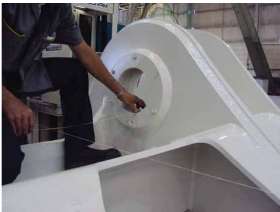
Figura 59 – Verificação dos diâmetros em relação à linha de centro da peça.
