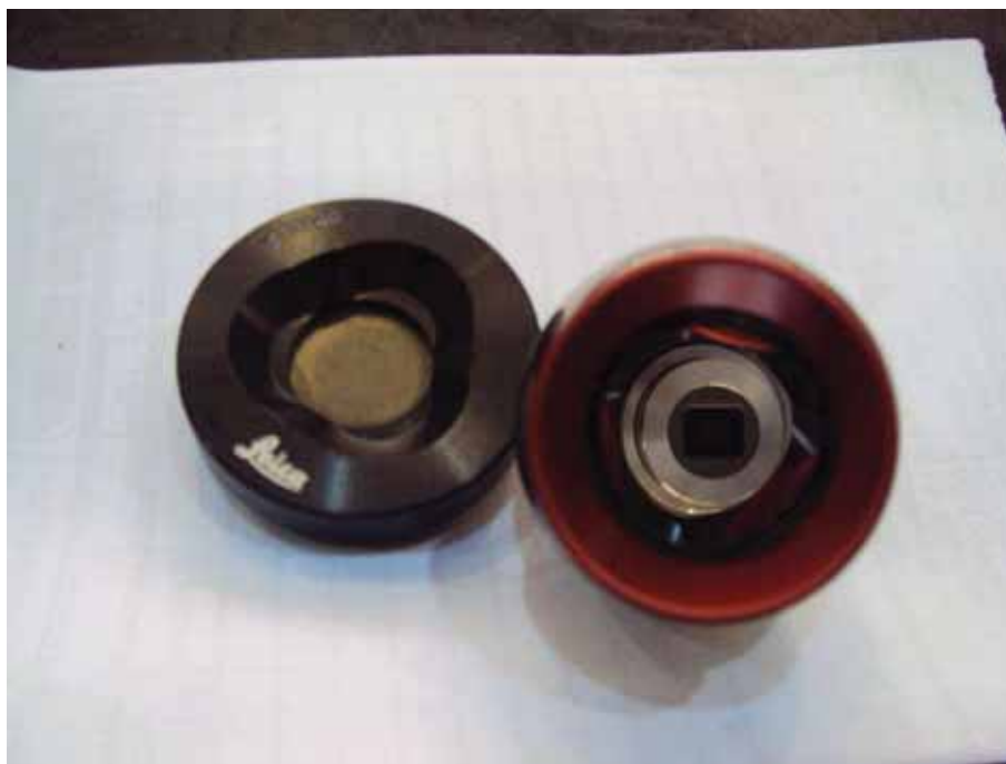
Figura 83 – Esfera refletora e ímã para captação do laser
