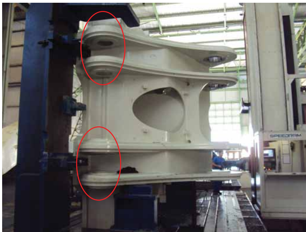
Figura 73 – Pontos fresados para referência na Fase C
