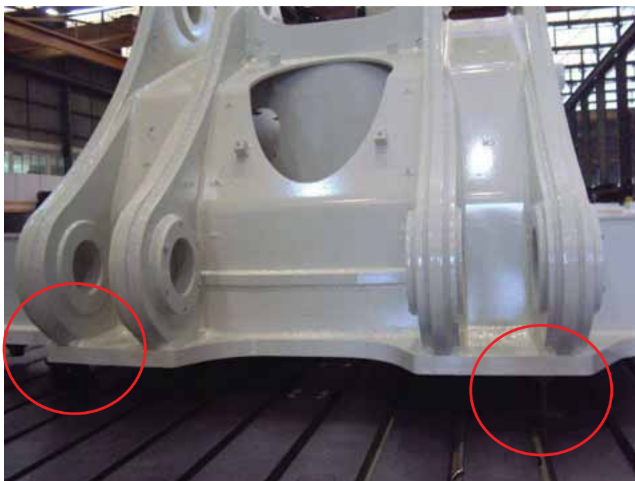
Figura 47 – Peça apoiada em dois trilhos
