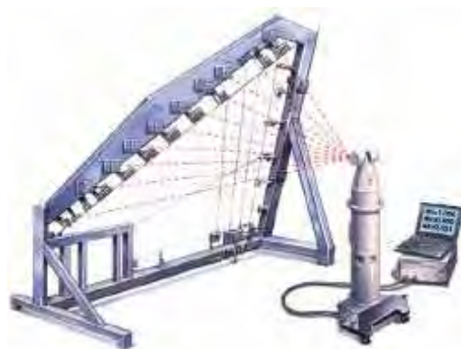
Figura 15 - Medição Automática com o ADM (CATÁLOGO LEICA, 1993).
