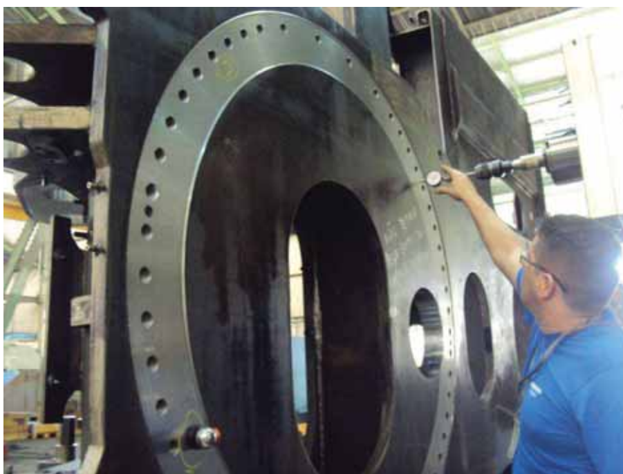
Figura 92 – Verificação da medição com o relógio comparador
