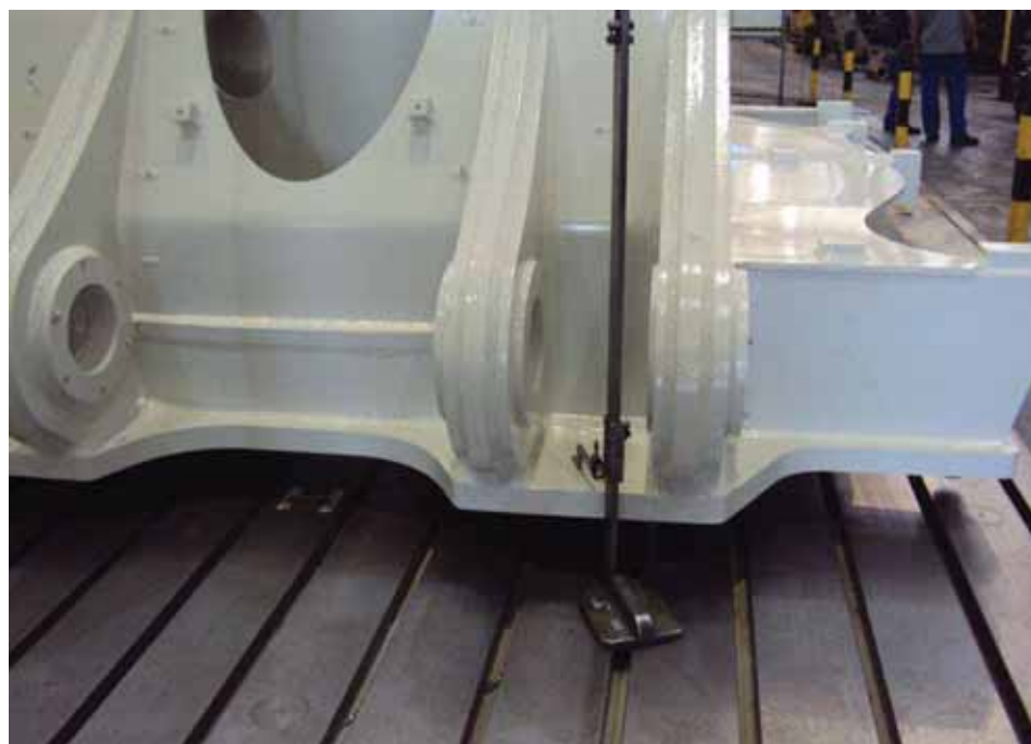
Figura 50 – Conferindo as medidas no outro lado da Plataforma.
