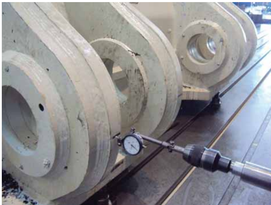
Figura 76 – Alinhamento para usinagem da Fase C
