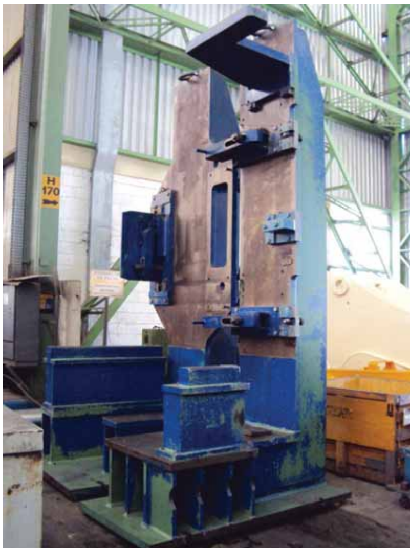
Figura 37 – Torres: Dispositivo de fixação da Plataforma
