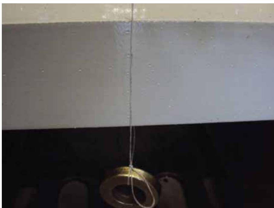
Figura 57 – Alinhamento do barbante na marcação feita na peça com um punção
