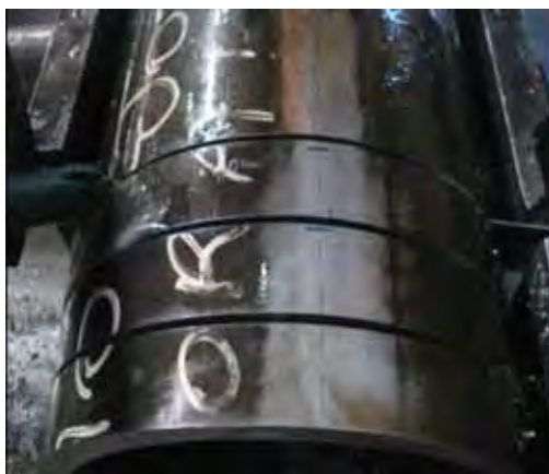
(a) Corte dos CPs do tubo
