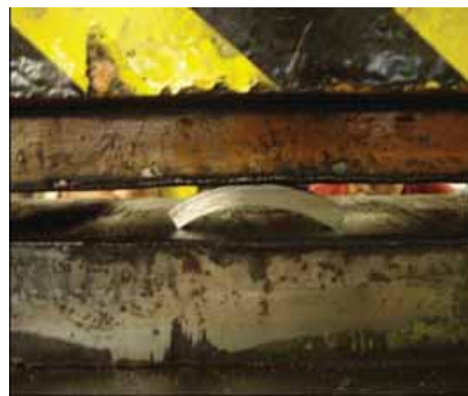
(b) Início da planificação dos CPs
