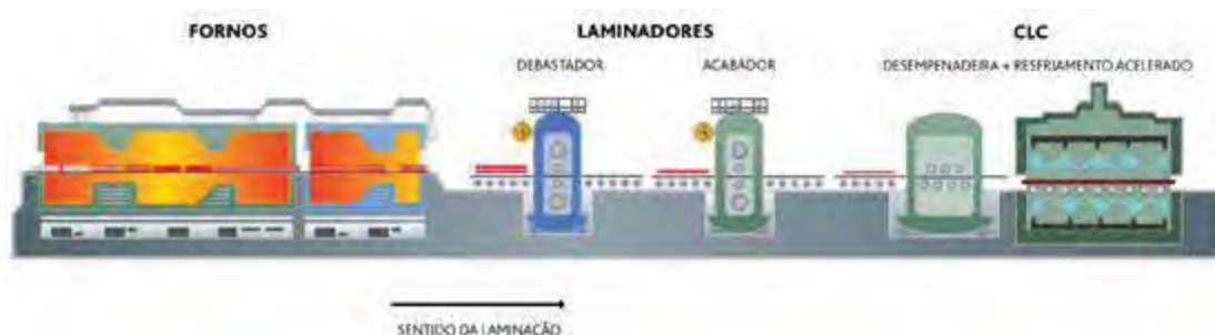
Figura 4: Laminação controlada com resfriamento acelerado (USIMINAS, 2011)
