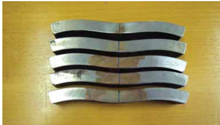
Figura 20: Grupo de corpos-de-prova preparados para o ensaio CTOD
