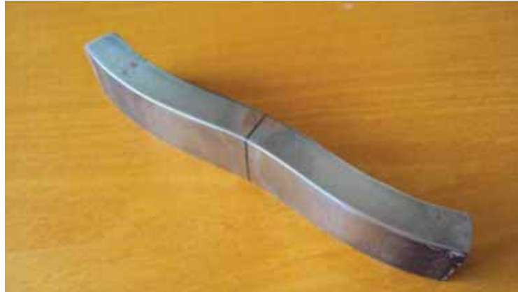
Figura 19: Entalhe confeccionado no corpo-de-prova do aço X70
