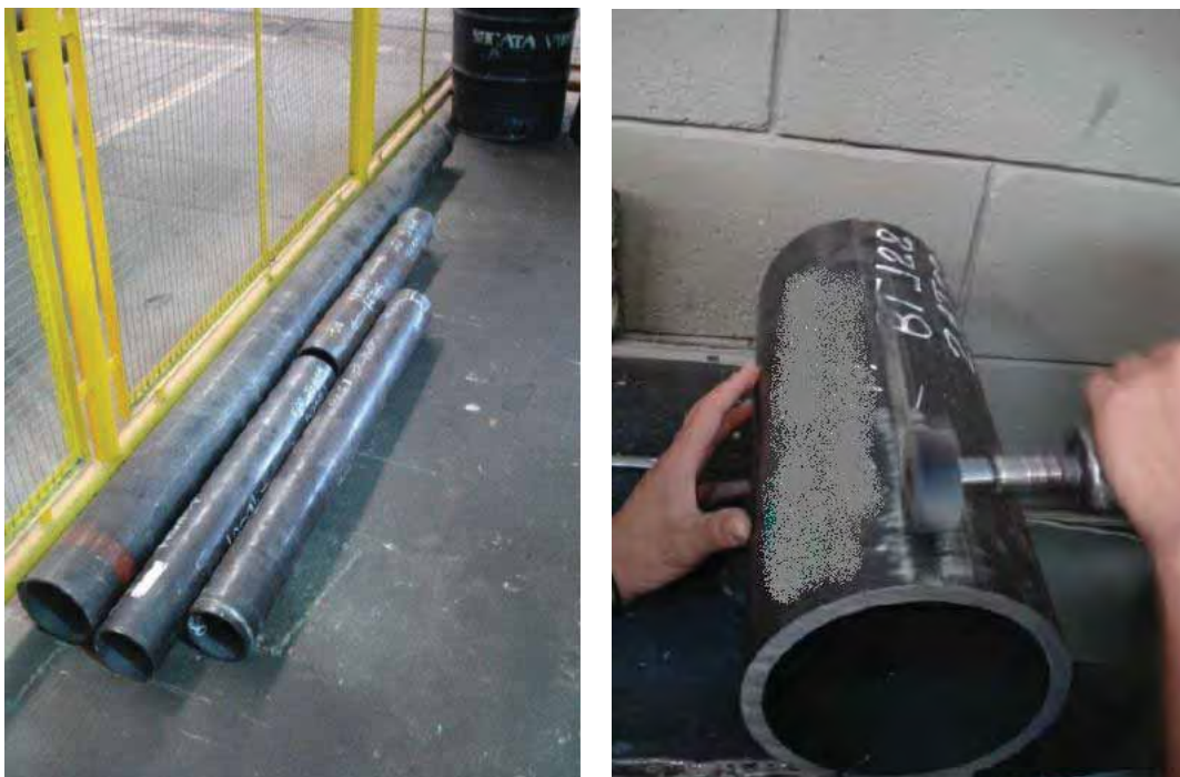
Figura 14: Tubo selecionado para retirada das amostras e preparação da junta soldada
