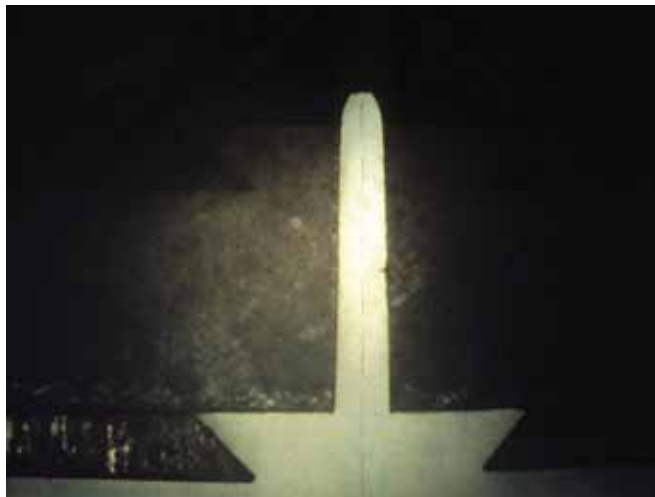
Figura 21: Medição do tamanho do entalhe
