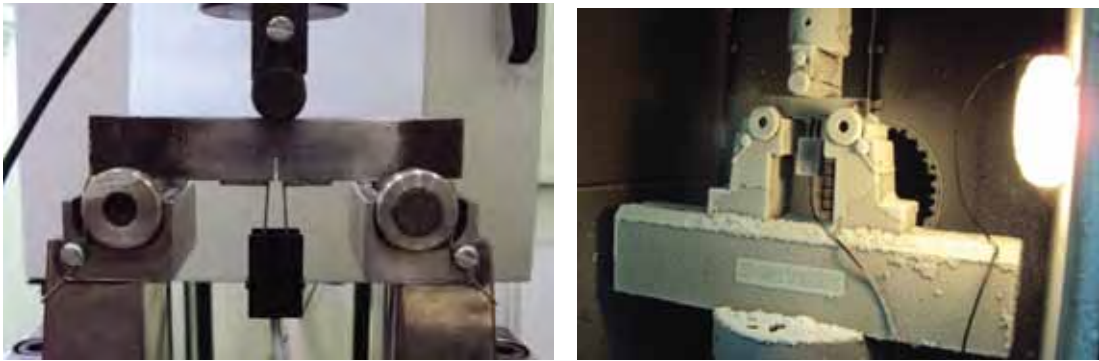
Figura 22: Corpo-de-prova SE(B) e dispositivo para ensaio de flexão de três pontos
