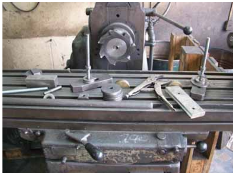
Figura 3.2 – Fresadora com guias de fixação para usinagem de uma etapa
