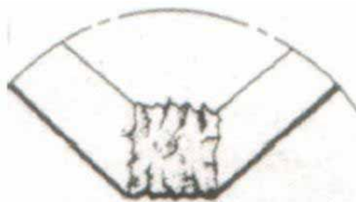
Figura 2: Avaria por quebra. Fonte: Sandvik (2012)
