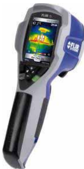
Figura 24: Câmera infravermelha utilizada na medição da temperatura.
