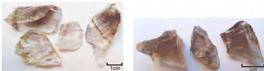
Foto 6 - Amostras provenientes de Diamantina (lote DI3) após aquecimento constante à 260°C, durante 15 minutos (esquerda) e 30 minutos (direita).
