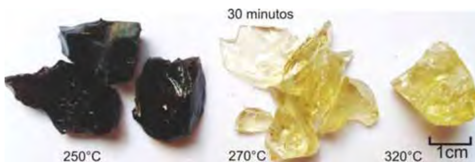
Foto 11 – Evolução das cores dos cristais de quartzo provenientes de Santana do Araguaia com tempo constante (30 minutos) e submetidos às diferentes temperaturas (250°C/270°C/320°C).
