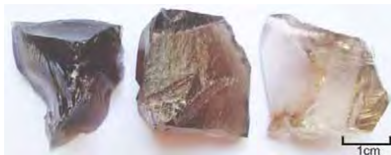
Foto 3 - Amostras provenientes de Diamantina (lote DI1) após aquecimento constante à 220°C durante 75 minutos.
