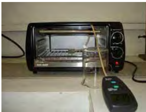
Foto 2 – Calibragem do forno Black & Decker-FT90 utilizando um termopar tipo K.
