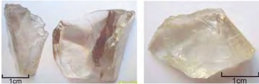
Foto 7 - Amostras provenientes de Diamantina (lote DI3) após aquecimento constante à 260°C, durante 45 minutos (esquerda) e 60 minutos (direita).
