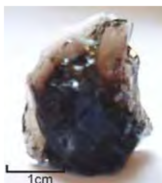
Foto 11 - Amostras provenientes de Santana do Araguaia (lote SA1) após aquecimento constante à 250°C, durante 75 minutos.
