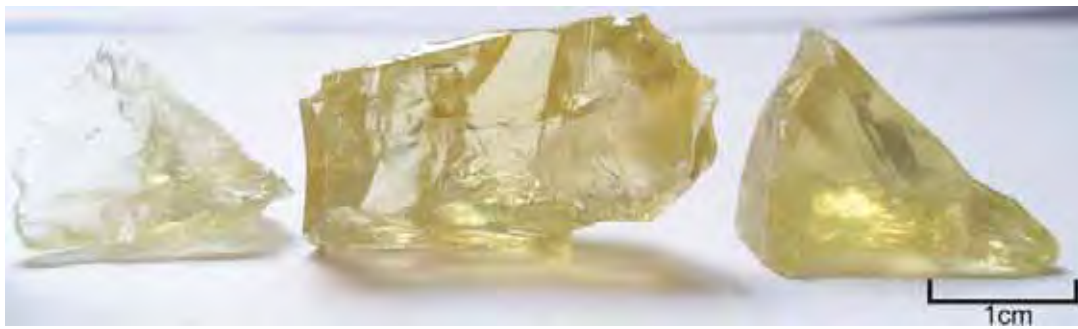
Foto 14 - Amostras provenientes de Santana do Araguaia (lote SA2) após aquecimento constante à 270°C, durante 60 minutos.
