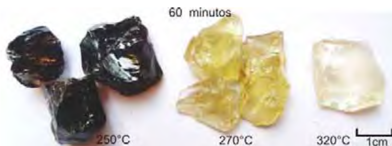
Foto 13 – Evolução das cores dos cristais de quartzo provenientes de Santana do Araguaia com tempo constante (60 minutos) e submetidos às diferentes temperaturas (250°C/270°C/320°C).
