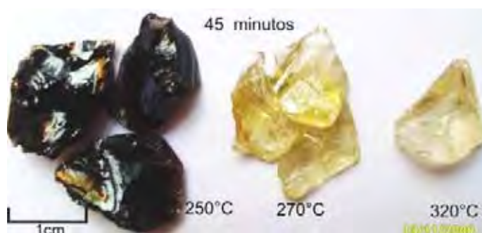
Foto 12 – Evolução das cores dos cristais de quartzo provenientes de Santana do Araguaia com tempo constante (45 minutos) e submetidos às diferentes temperaturas (250°C/270°C/320°C).
