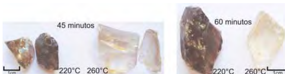
Foto 8 – Evolução das cores dos cristais de quartzo provenientes de Diamantina com tempos constantes (45 e 60 minutos), e submetidos às diferentes temperaturas (220°C/260°C).
