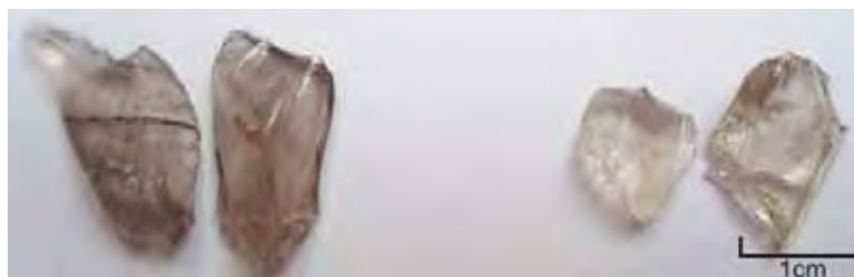
Foto 6 – Cristais de quartzo provenientes de Diamantina (lote DI3), aquecidos à temperatura constante de 260°C durante 15 minutos.
