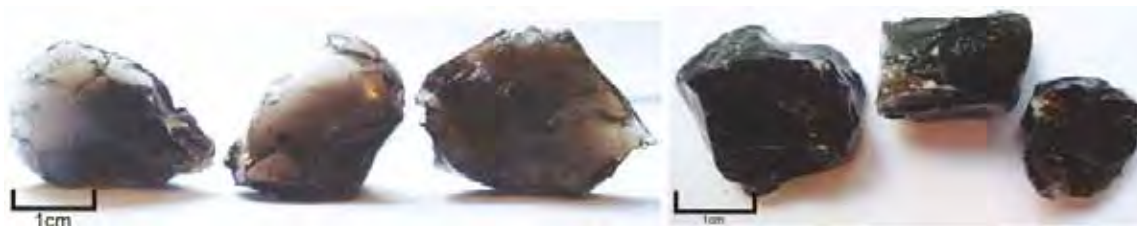
Foto 10 - Amostras provenientes de Santana do Araguaia (lote SA1) após aquecimento constante à 250°C, durante 45 minutos (esquerda) e 60 minutos (direita).
