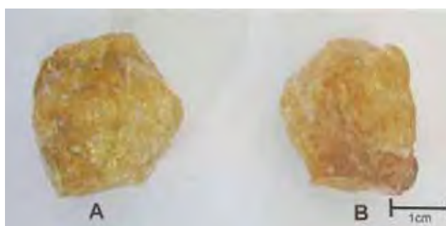
Foto 3– Cristais de quartzo provenientes de Corinto (lote CO1) após aquecimento a uma temperatura de 220°C (cristal A) e 260°C (cristal B).
