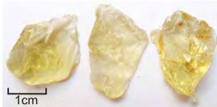
Foto 13 - Amostras provenientes de Santana do Araguaia (lote SA2) após aquecimento constante à 270°C, durante 45 minutos.
