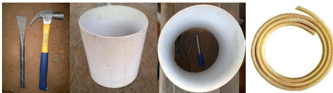
Figura 42 - Ferramentas e Materiais utilizados na vedação da câmara para vedação na análise de VOC's.
