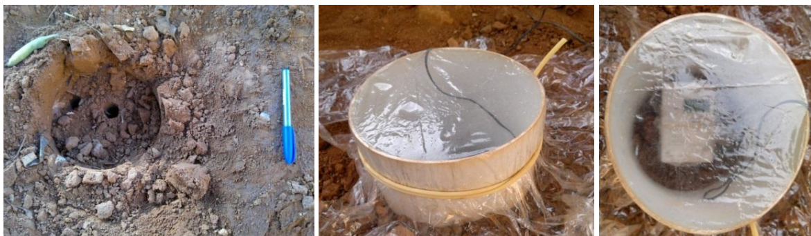
Figura 43 - Furo realizado para sondagem e câmara de vedação com dispositivo para detecção de VOC's.
