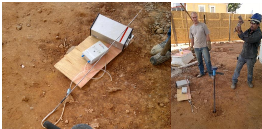
Figura 40 - Equipamento AlphaGuard expelindo gases da câmara para realização de nova medida e procedimento para perfuração a trado.
