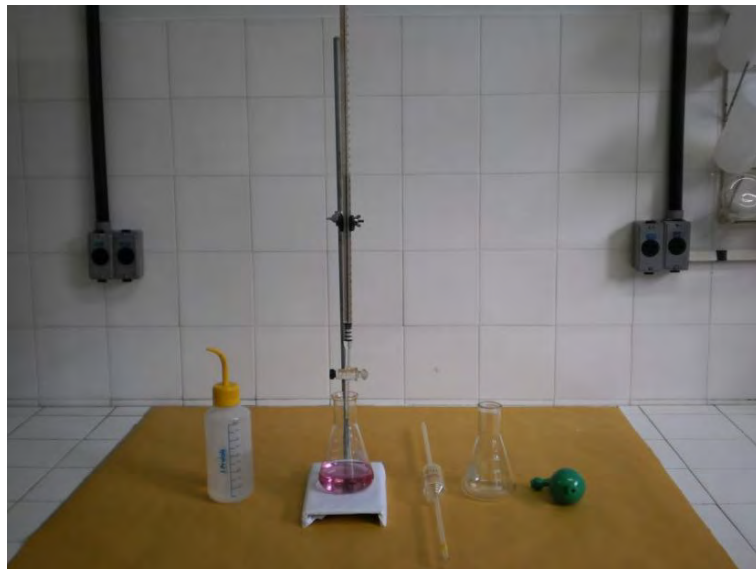
Figura 4-45: Elemeyer (250ml), bureta (50ml), pipeta, suporte universal e garra
