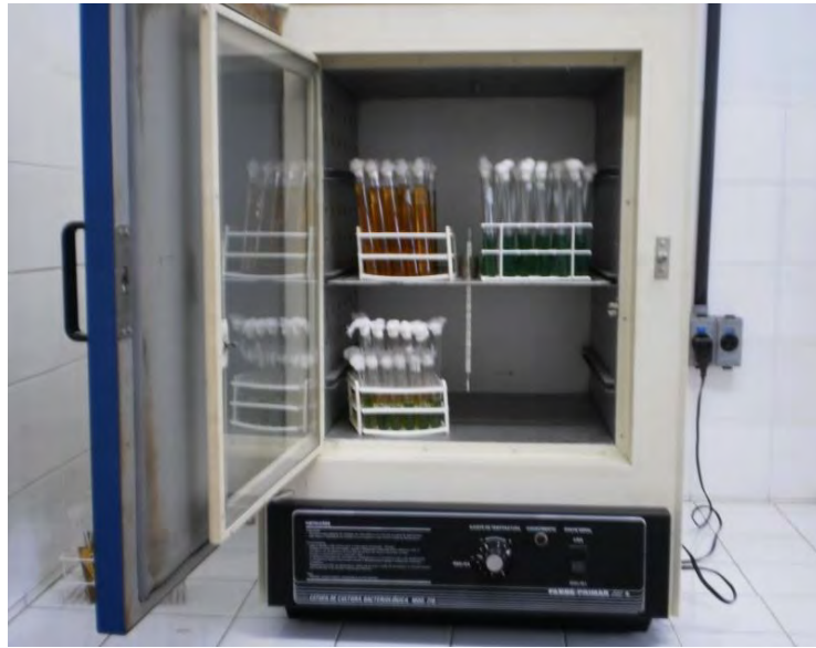
Figura 4-39: Estufa Bacteriológica – modelo:216 – marca: FANEM
