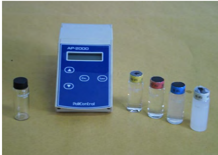
Figura 4-49: Turbidímetro – marca: Policontrol – modelo: AP 2000
