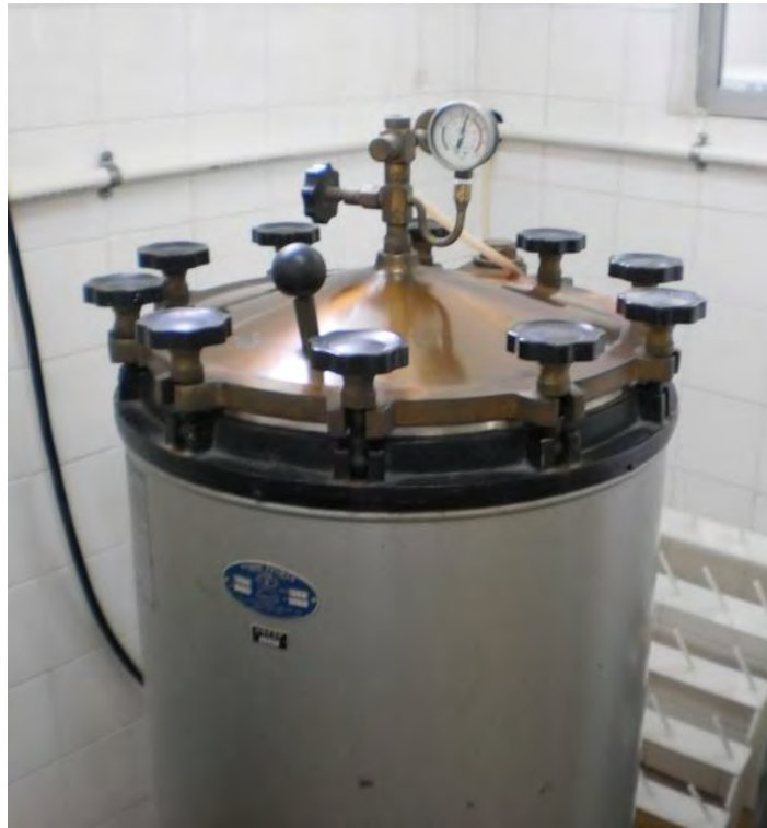
Figura 4-40: Autoclave – Modelo Fabbe-Primar
