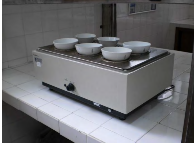
Figura 4-41: Banho Maria (cápsulas de porcelana de 250 ml) - marca: Fisatom
