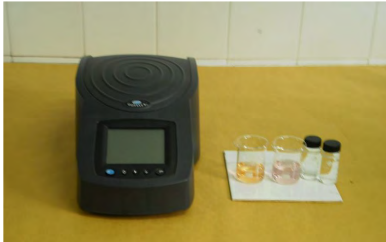
Figura 4-46: Espectro Fotômetro– marca: Hach Odyssey– modelo: DR 2500
