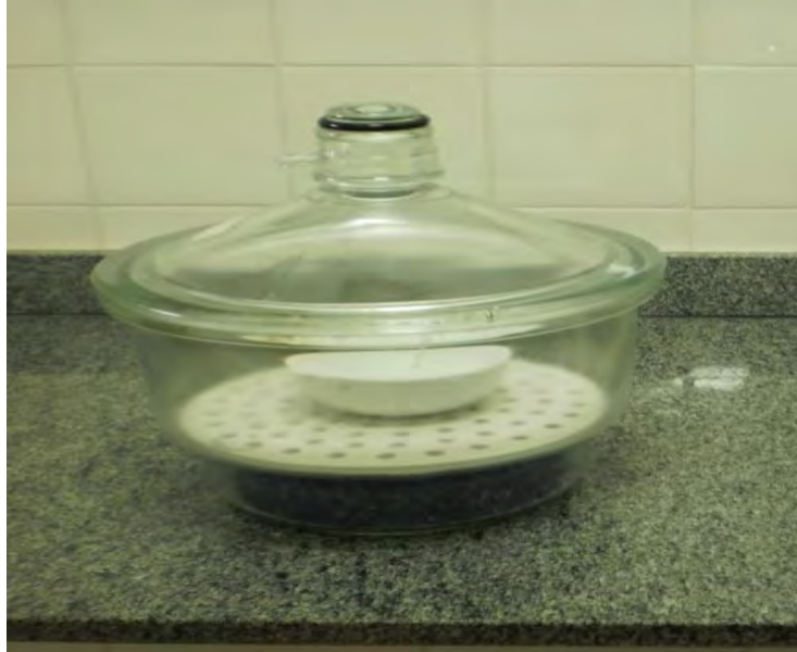
Figura 4-43: Dessecador (agente dessecante é a sílica gel azul)
