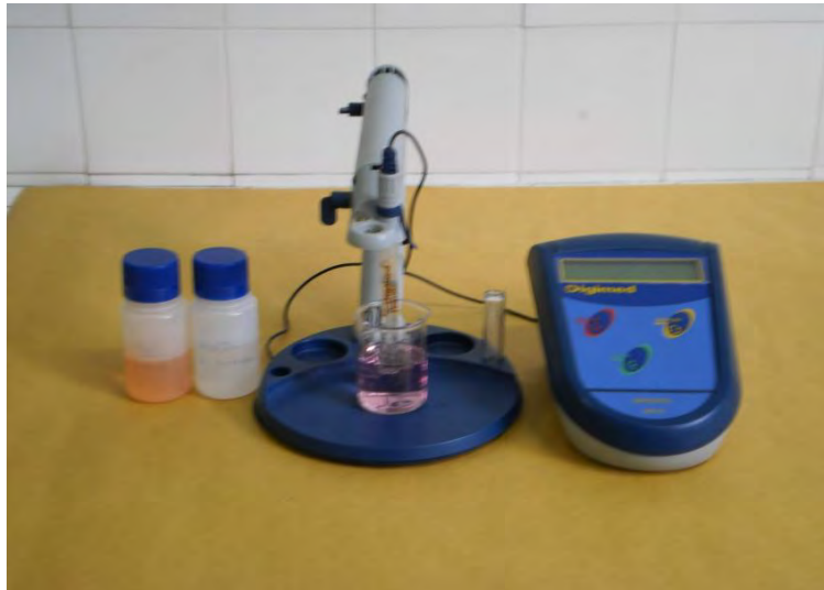
Figura 4-47: PHmetro – marca: Digimed – modelo: DM 22
