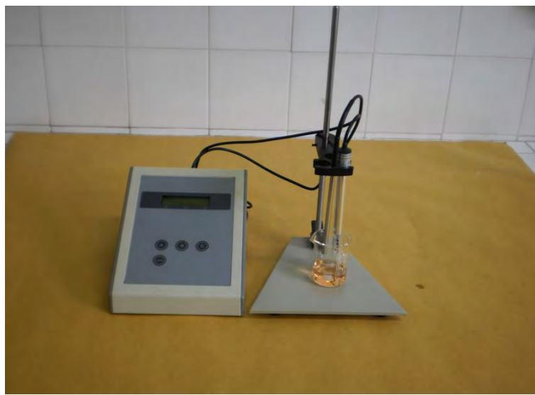
Figura 4-48: Condutivímetro – marca: Marconi – modelo: CA 150
