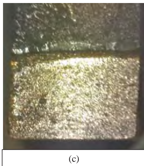
Figura 69 - Ensaio de CTOD da linha de solda 12 a -100^{\circ}\text{C} : (a) gráfico Carga [kN] versus CMOD [mm] fornecido pela máquina (b) curva Carga [kN] versus CMOD [mm]; (c) superfície de fratura.
