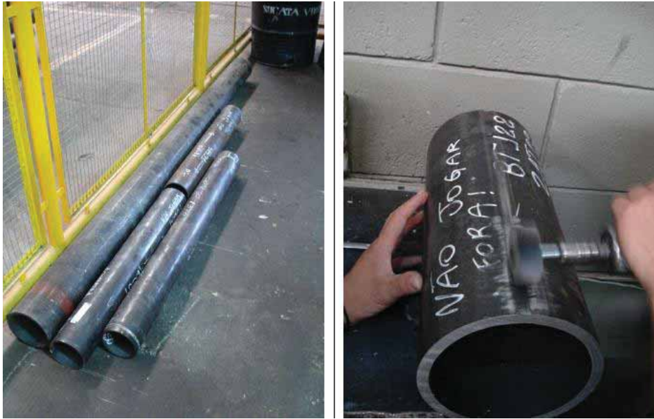
Figura 29 - Modelo dos tubos selecionados para a retirada dos espécimes para a caracterização microestrutural e mecânica.
