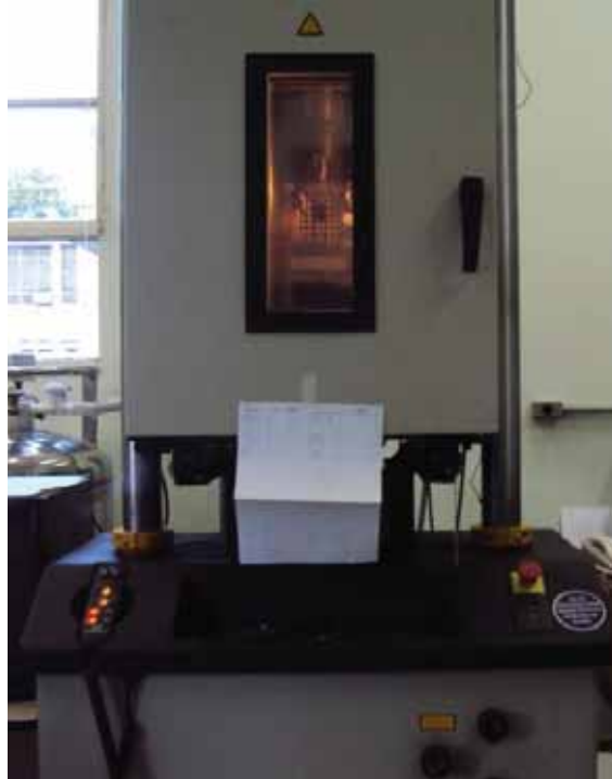
Figura 38 - Máquina universal (servo-hidráulica) de modelo INSTRON 8801 com câmara térmica integrada.
