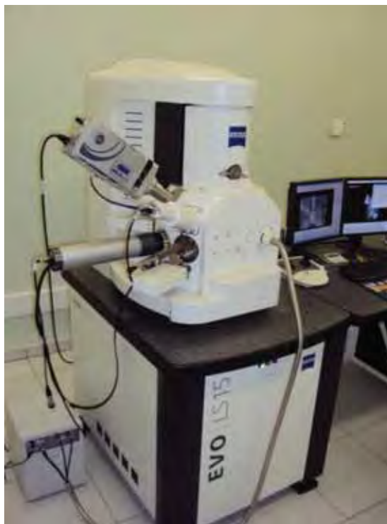
Figura 30 - Microscópio eletrônico de varredura pertencente ao DMT/FEG/UNESP utilizado na análise microestrutural e microfractográfica.
