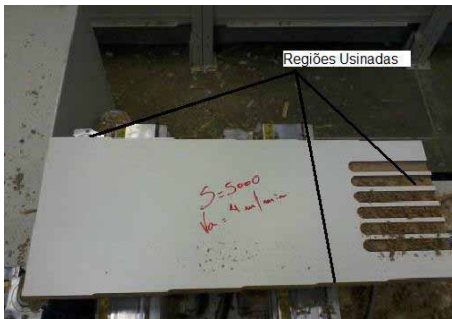
Figura 15. Painel com seis trechos usinados de cada corte.
