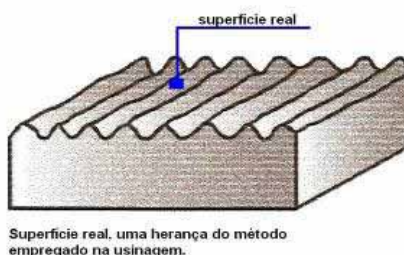
Figura 8. Superfície real de um corpo (Medidas e Medições, Curso de Metrologia. Prof. Ms. Emilio Dionísio Porto Diniz, 2009)
