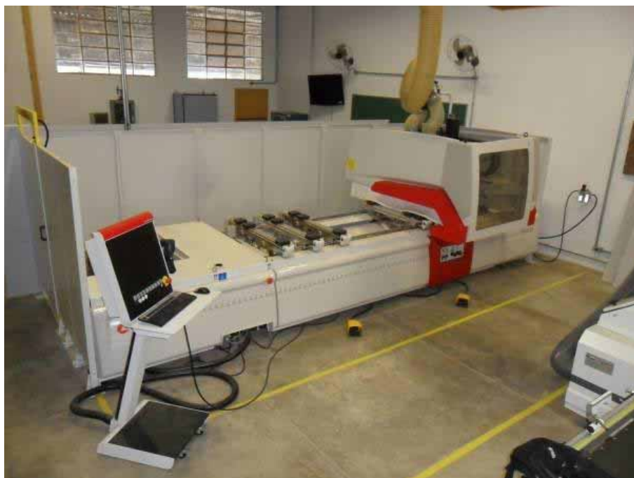
Figura 19. Furadeira – Fresadora CNC Tech Z1 (SCM GROUP S.P.A – Manual de Instruções, 2011, in ALMEIDA, 2013).
